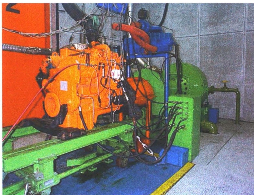
Figura 4- Área de preparação de motor para instalação em dinamômetro.
