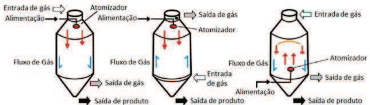
Figura 6. Configurações típicas em spray drying (PEIGHAMBARDUST, et al., 2011; VEGAMERCADO, et al., 2001)
