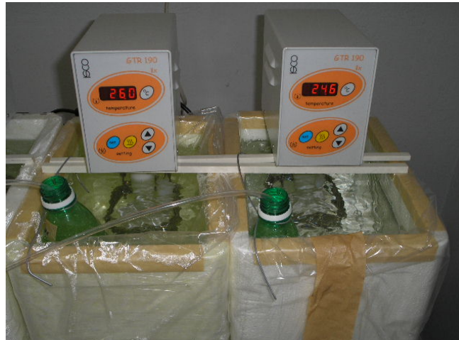
Figura 2 – Sistema de banho-maria com os recipientes para oxigenação utilizados na incubação dos ovos em diferentes temperaturas.
