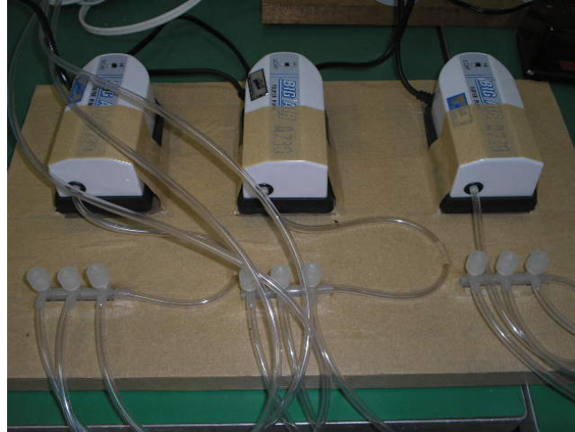
Figura 1 – Sistema de bombas de ar para aquário utilizadas no processo de oxigenação dos ovos para ativar o processo embrionário durante o período de incubação.
