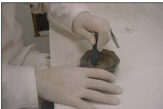
As amostras foram trituradas e homogeneizadas em almofariz de ágata.
