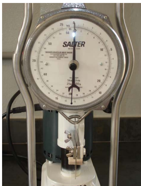
Figura 18 – Determinação da força de cisalhamento da carne por lâmina tipo Warner Bratzler
