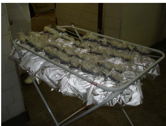
Figura 9 – Amostras de carne envoltas por malha e suspensas por sacos plásticos para determinação das perdas de água por exsudação
