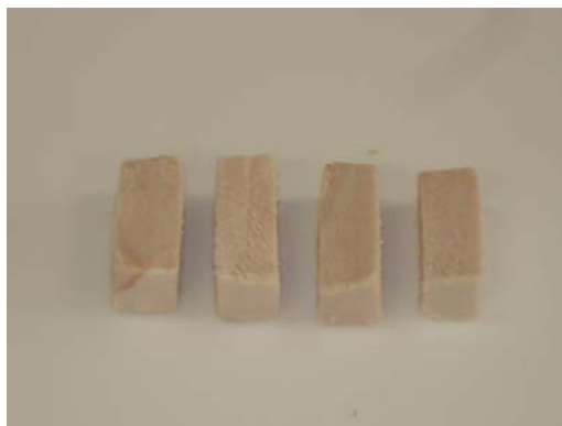
Figura 17 – Paralelepípedos retirados das amostras de carne após assadas para determinação da força de cisalhamento
