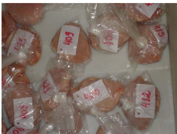
Figura 11 – Amostras de carne acondicionadas em sacos plásticos para posterior congelamento e determinação das perdas de água por descongelamento
