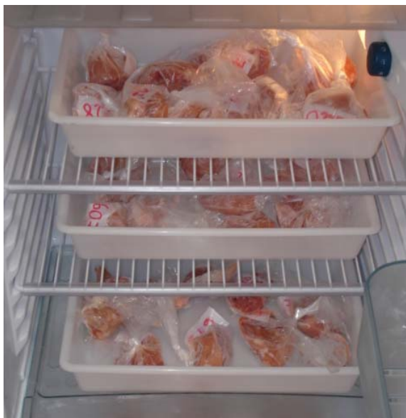
Figura 13 – Descongelamento das amostras destinadas à determinação das perdas por descongelamento em refrigerador
