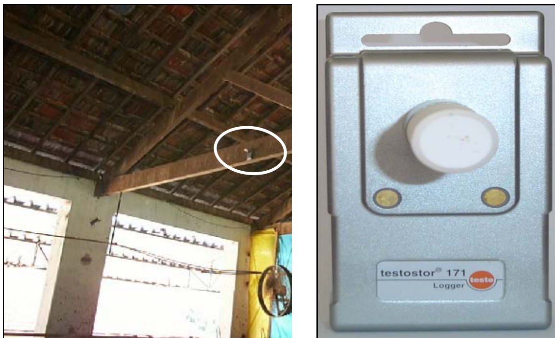
Figura 9- Registrador digital utilizado nas medidas de temperatura e umidade relativa do ar no interior do free-stall .
