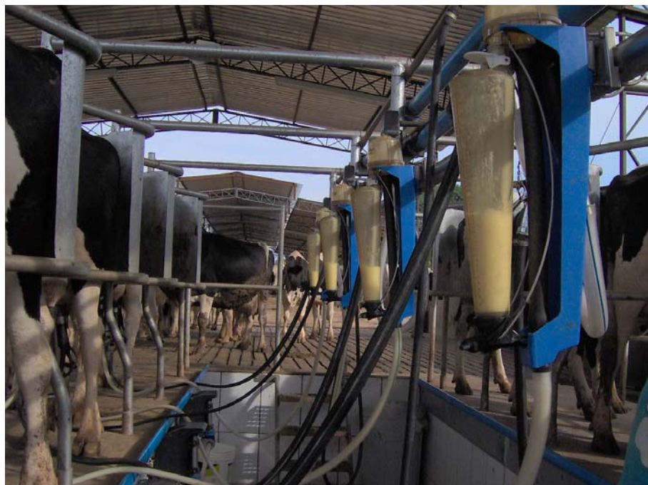
FIGURA 11: Sistema de ordenha tipo balde ao pé, utilizado principalmente em propriedade leiteira de pequeno e médio porte.
