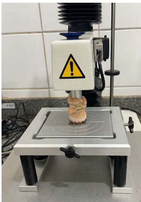
Figura 4.2. Texturômetro com a pele fixada para análise de mucoadesividade.
