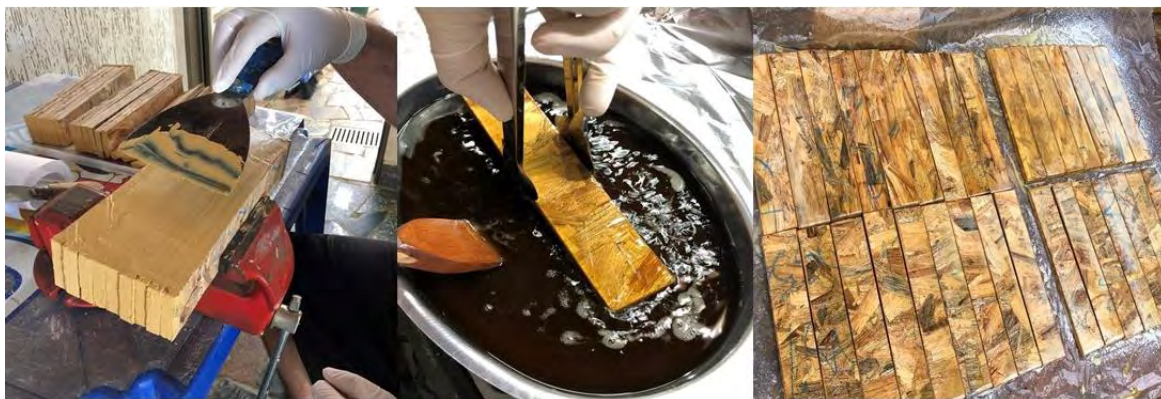
Figura 15 - Revestimento dos corpos de prova. (a) Bordas laterais com massa acrílica para madeira. (b) Aplicação do TC. (c) Aplicação do TPU. Fonte: Próprio autor
