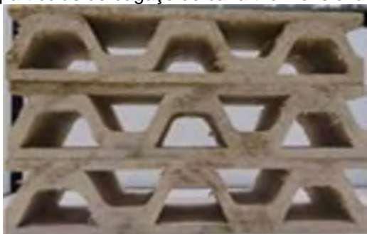
Figura 12 – Painel de partículas de bagaço de cana tridimensional com núcleo trapezoidal
