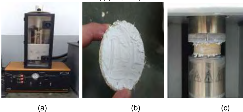
Figura 24 – Ensaio térmico: (a) máquina de ensaio; (b) corpo de prova recoberto com pasta térmica; (c) corpo de prova em ensaio
