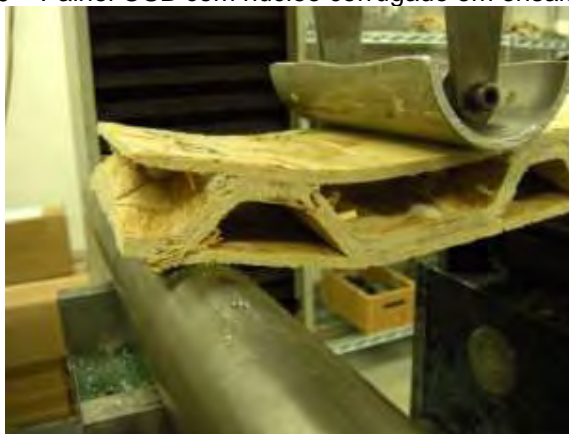
Figura 10 – Painel OSB com núcleo corrugado em ensaio de flexão
