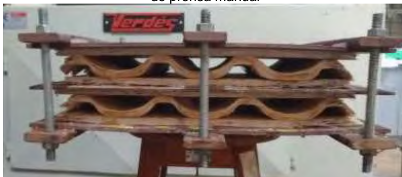
Figura 22 – Procedimento de colagem das faces planas com o núcleo ondulado com auxílio de prensa manual
