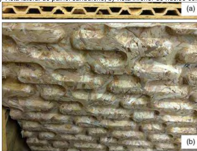
Figura 11 - a) Vista lateral do painel sanduíche; b) vista inferior do núcleo corrugado
