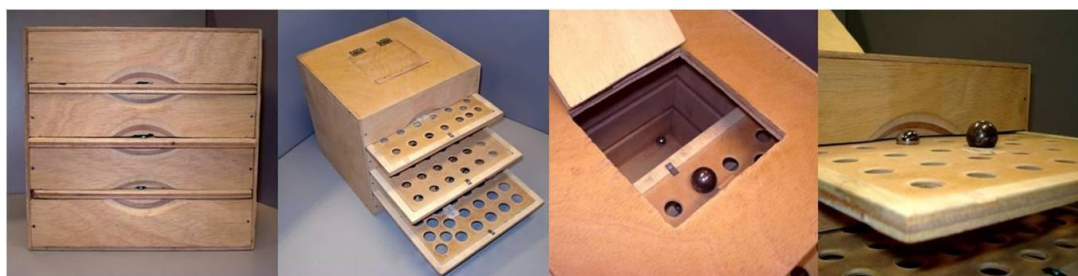
Figura 38: caixa de gavetas, que funcionam como peneiras, seus orifícios apresentando diferentes diâmetros. Na situação da terceira foto (da esquerda para a direita), uma das bolas ficou retida na peneira com furos de 2,0 cm de diâmetro.
