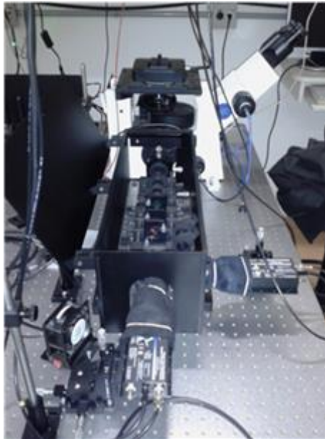
Figura 12: Detalhes do microscópio confocal construído com múltiplas capacidades. Linha confocal com dois detectores pontuais tipo APD, IX71 com Piezoelétrico PI, e saída lateral para medidas espectrais.
