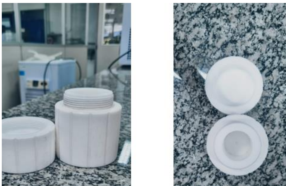
Figura 5 - Reator empregado no uso das sínteses das MOFs. A) vista frontal. B) vista lateral.
