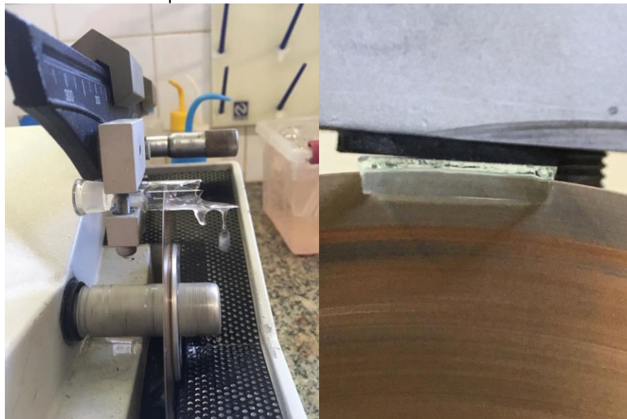
Figura 12- Substrato de vidro contendo óxido de estanho dopado com flúor previamente cortado para a clivagem e análise transversal por MEV.
