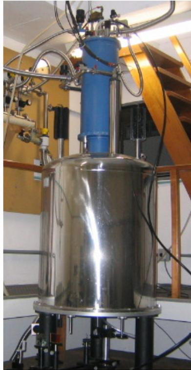
*Figura 2.10: Criostato onde as amostras eram colocadas a fim de estudar os fenômenos de transporte em baixas temperaturas. Através de uma abertura na parte superior do criostato, colocava-se a amostra, usando uma vareta, que a conectava ao sistema de aquisição de dados.*
