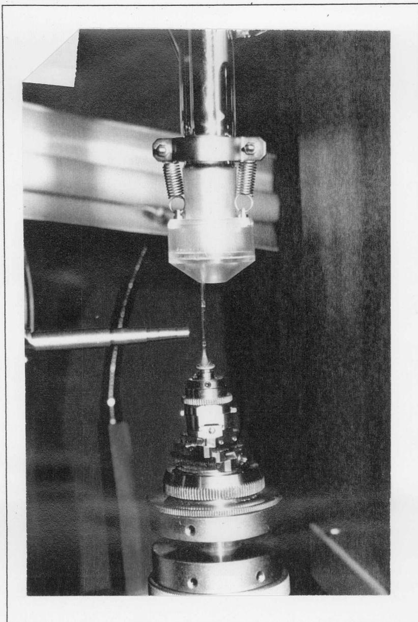
Figura 2.4 - Fotografia do sistema de coleta de dados R-AXIS IIC, da Rigaku Corp., mostrando em detalhes o local onde é colocado o cristal para experimentos de difração de raios-X.
