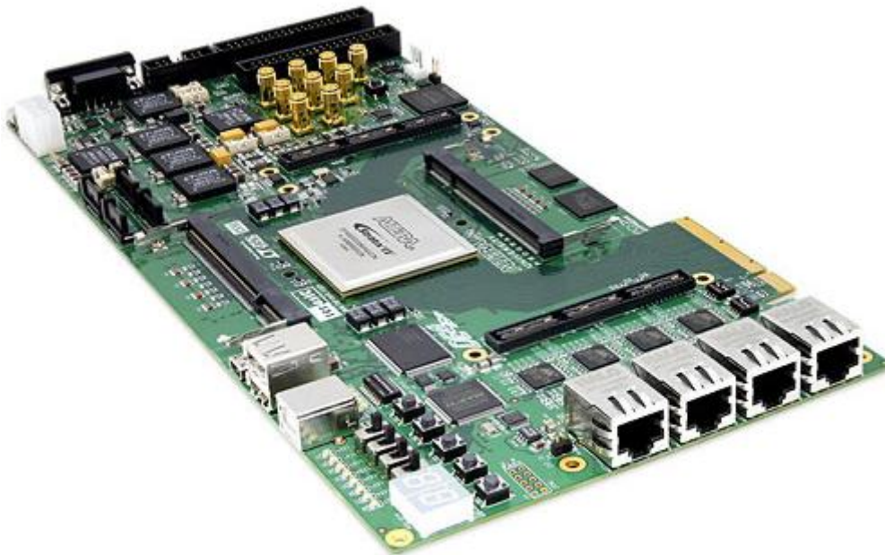
Figura 4.3 - Kit de desenvolvimento DE4 da Terasic, o qual contém um FPGA Straix IV da Altera e quatro interfaces Gigabit Ethernet. Fonte: TERASIC-SOCKIT (18).
