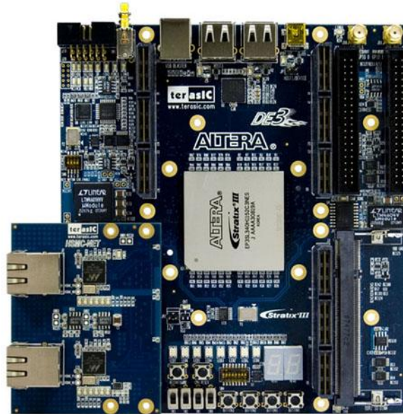
Figura 3.2 - Placa HSMC-NET da Terasic, mostrada conectando-se ao kit DE3 através do duto HSMC. Fonte: TERASIC-SOCKET (18).
