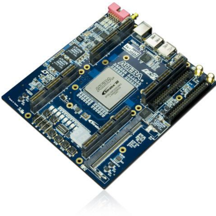
Figura 3.1 - Kit de desenvolvimento DE3-150 da Terasic, utilizado para verificação e validação do sistema desenvolvido. Fonte: TERASIC-SOCKET (18).
