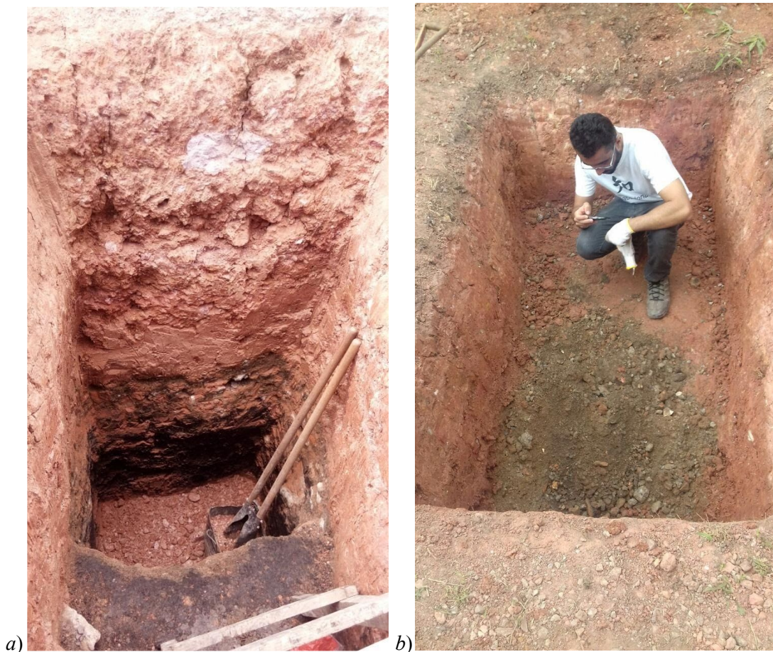
Figura 23) a) Processo de abertura da trincheira TR02/TRAD2 (tirada em Agosto, 2017); b) – Processo de abertura da trincheira TR01/TRAD1 (tirada em Maio, 2017).
