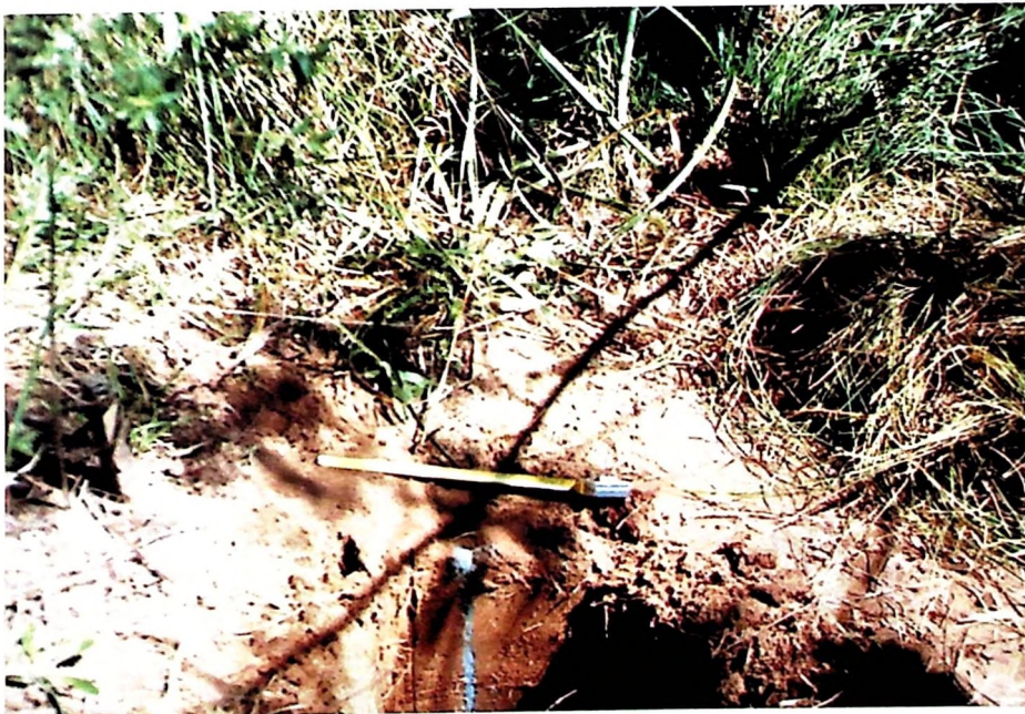
Figura 28 - Coluna de areias injetada em vertente de litologia arenítica, com forte declividade e coberta pela vegetação (terço inferior da Vertente 2).
