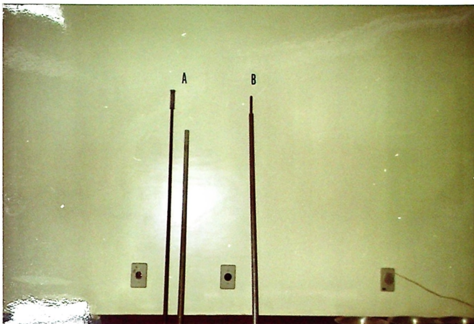
Figura 11 - Equipamento utilizado no estudo experimental sobre o movimento de rastejo. Em (A) estão o tubo de aço oco e o tubo de aço maciço. Em (B) os tubos estão preparados para serem injetados no solo.
