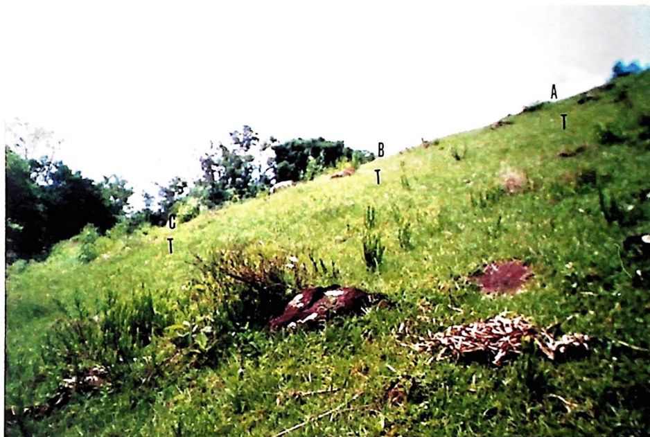
Figura 13 - Perfil de uma das vertentes escolhidas para o estudo do rastejo. As três estacas indicam os pontos onde foram injetadas as areias: no terço superior (A), no terço médio (B) e no terço inferior (C).
