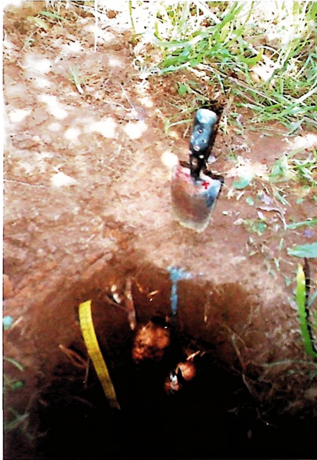
Figura 39 - Coluna de areias coloridas injetada em vertente de litologia basáltica, com forte declividade e sem cobertura vegetal (terço médio da Vertente 8).
