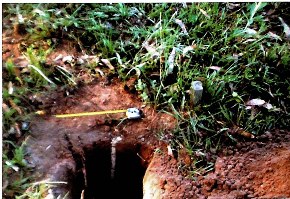
Figura 30 - Coluna de areias injetada em vertente de litologia arenítica, com fraca declividade e sem cobertura vegetal (terço inferior da Vertente 3).
