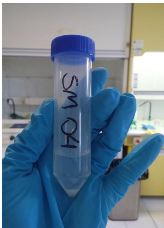
**Figura 28** Precipitado formado no fundo do tubo após as sucessivas etapas de limpeza e centrifugação.
