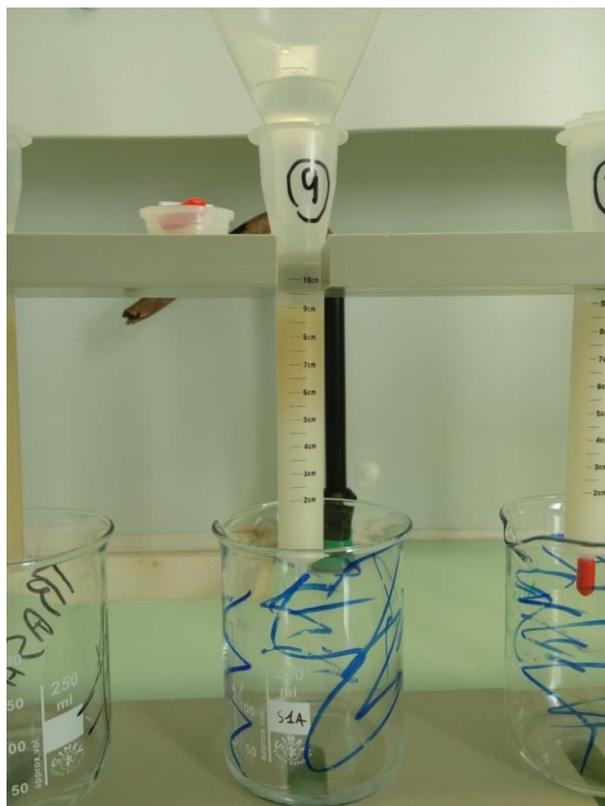
**Figura 27** Momento em que são introduzidos os 20mL de HCl a  $10,2\text{mol.L}^{-1}$  na coluna de resina aniônica. A coluna se torna amarela após a passagem do referido ácido.
