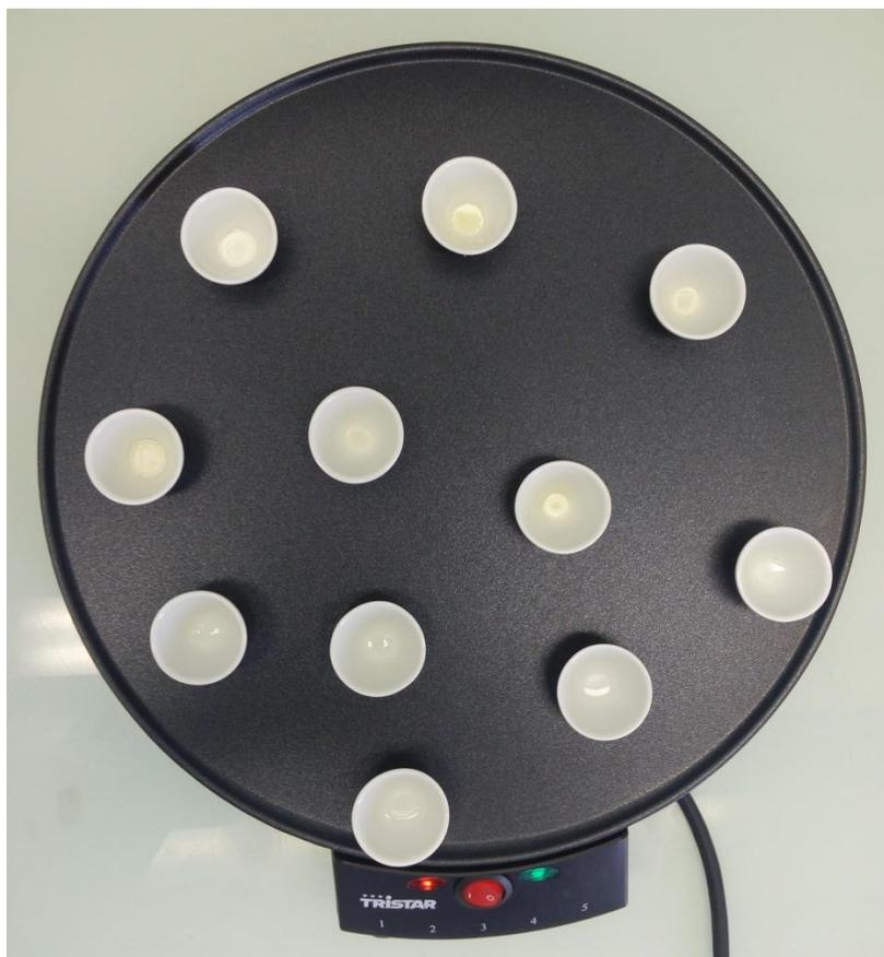
**Figura 29** Amostras sendo evaporadas para posteriormente serem levadas ao forno para a etapa de Oxidação. Nota-se que, próximo ao final do processo em laboratório, a amostra é reduzida a um pequeno resíduo em pó.
