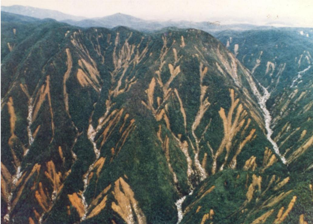
**Figura 17** Escorregamentos rasos generalizados nas encostas da Serra do Mar em Cubatão (SP), em 1985. Nota-se que o material mobilizado pelos escorregamentos se concentrou nas drenagens, resultando em corridas de detritos. Foto: Arquivo IPT.
