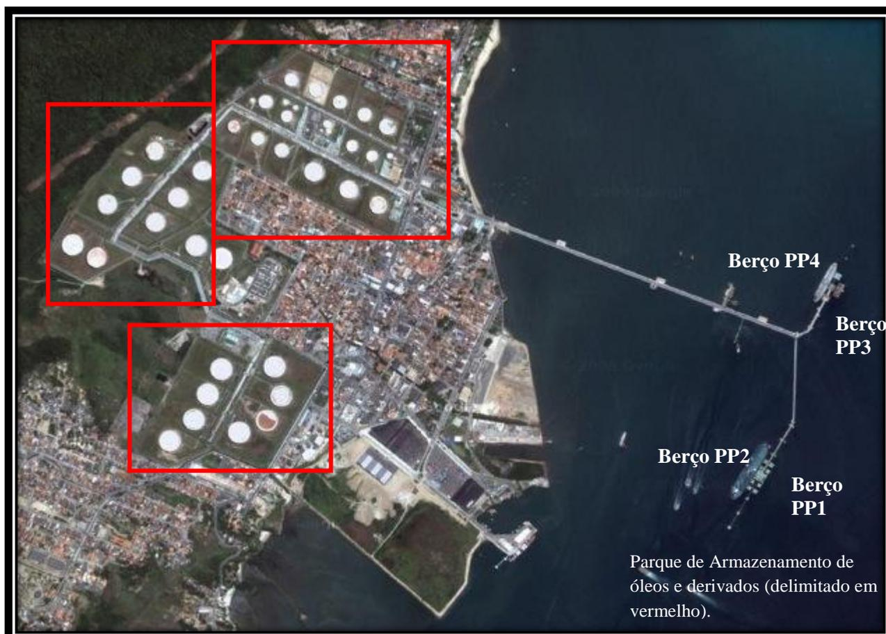
**Figura 12:** Área ocupada pelo TEBAR, com localização dos respectivos berços de atracação e tanques de armazenamento. Como se pode notar, o terminal pode operar com até quatro navios atracados simultaneamente. Fonte: Google Earth (acesso em nov/2009). Adaptado por Heloisa dos S. Reis (2011).
