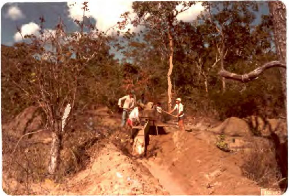
Foto 13 - Lavagem e concentração de minério na "caixa", utilizando motor, na Grota Rica; procedimento em descenso no garimpo Areia, por causa dos custos. Este processo é semelhante ao utilizado no garimpo Ingazeira, com a diferença de que, lá, no alto da "caixa", coloca-se o moinho para britar o minério proveniente de depósito primário. Maio de 1981.
