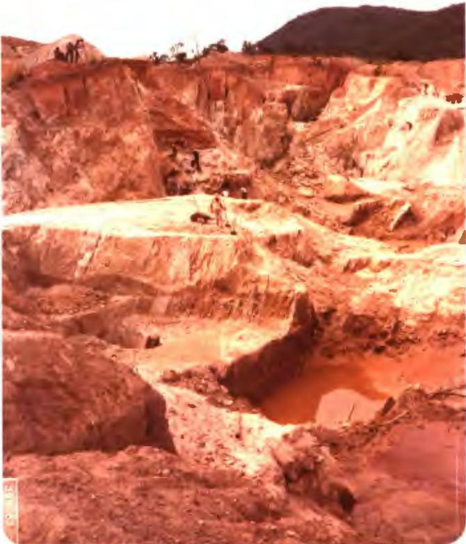
Foto 8 - Nos "serviços" com profundidade superior a 10 metros as "banquetas", nível intermediário, facilitam o trabalho manual de retirada do estéril e do minério, no garimpo Ingazeira. Junho de 1981.
