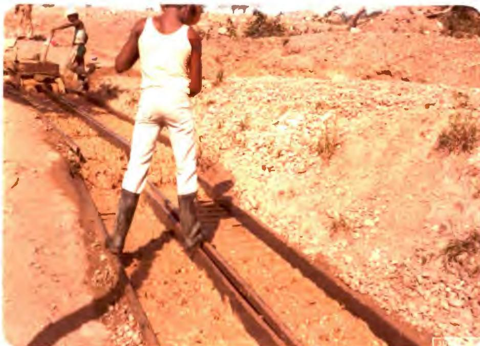
Foto 22 - A bica canadense é uma modalidade de *sluice* ou de "caixa", com melhor aproveitamento do minério. Foi desenvolvida, inicialmente, pela Tricontinental e depois pela METAGO, com a finalidade de dar maior rendimento à atividade garimpeira. Riacho dos Cavalos, junho de 1981.
