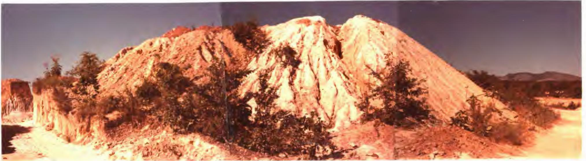
Foto 9 - Na mineração pequena ou grande é fundamental a retirada do estéril da área mineralizada. Nos garimpos, este material fica entulhado nas proximidades do "monchão". À esquerda, vê-se o local de entrada de caminhões-basculantes, no garimpo Ingazeira. Junho de 1981.
