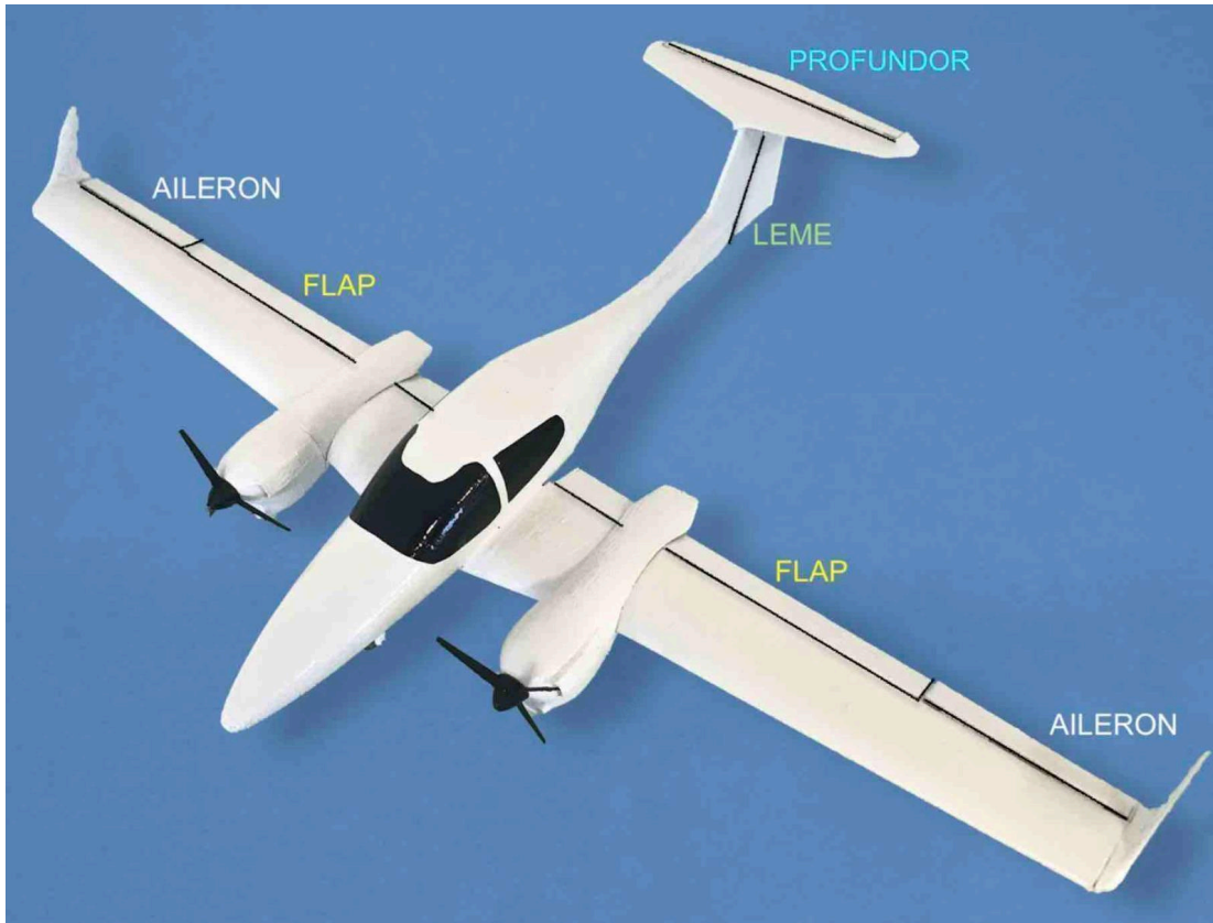
Figura 3. Superfícies de comando da aeronave Diamond DA42 .
