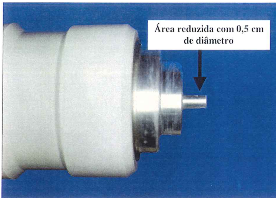
Figura 6 – Cabeçote do ultra-som, mostrando área reduzida.
