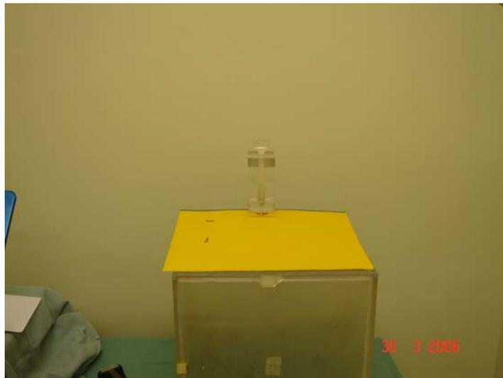
**Figura 3.4-6** – Simulador com placa de I-125 fixada e filme radiográfico posicionado para experimento.
