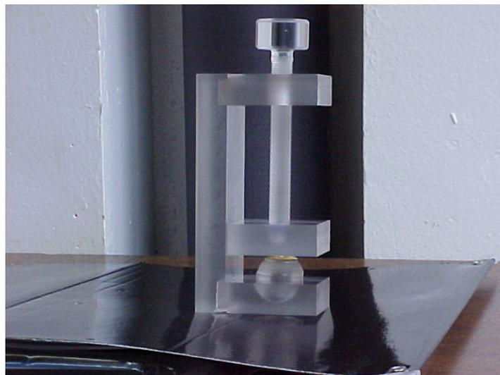
**Figura 3.4-3** – Foto do simulador montado com uma folha de ouro em cima da esfera que representa o olho.
