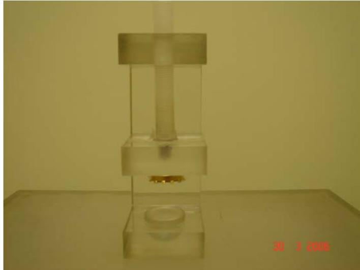
**Figura 3.4-5** – Simulador com placa de I-125 fixada.
