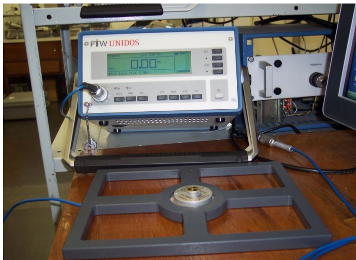
FIGURA 22: Câmara de ionização PTW 77334, conectada ao eletrômetro UNIDOS e a fonte de controle de ^{14}\text{C} posicionada sobre a câmara.
