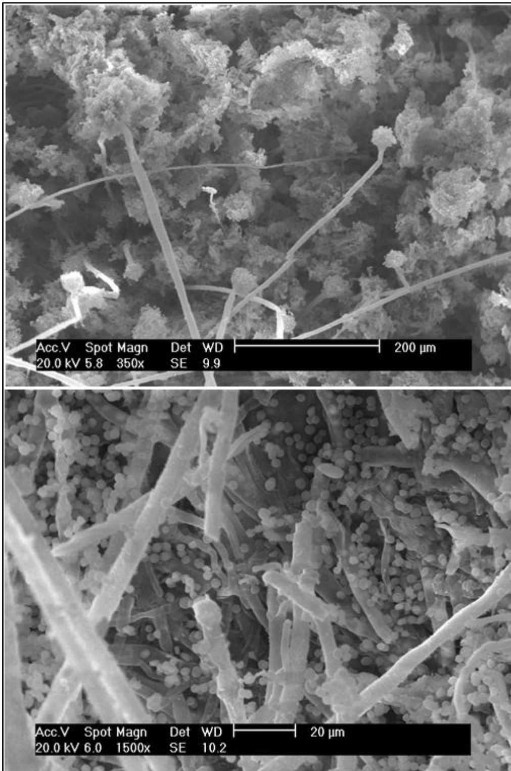
FIGURA 16 - Imagens microscópicas das alterações causadas após a irradiação com 20 kGy (superior: ^{60}\text{Co} e inferior: feixes de elétrons).
