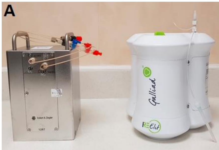
Figura 16 - Geradores de germânio-68 ( ^{68}\text{Ge} ) /gálio-68 ( ^{68}\text{Ga} ) de grau radiofarmacêutico BPF. Em A da esquerda para a direita: Galliapharm ® do fabricante Eckert & ziegler, Galli Ad ® do fabricante IRE e em B GeGant ® do fabricante ITG.
