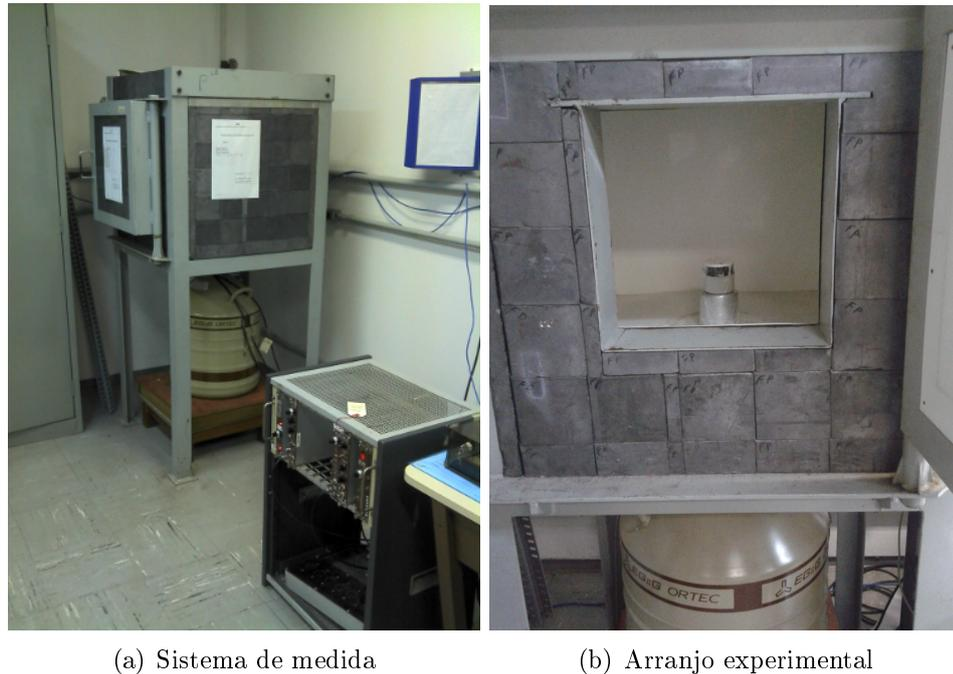
**Figura 4.3:** (a) Sistema de medida (b) Detector HPGe série GEM Ortec com respectiva blindagem e amostra na geometria de medida.
