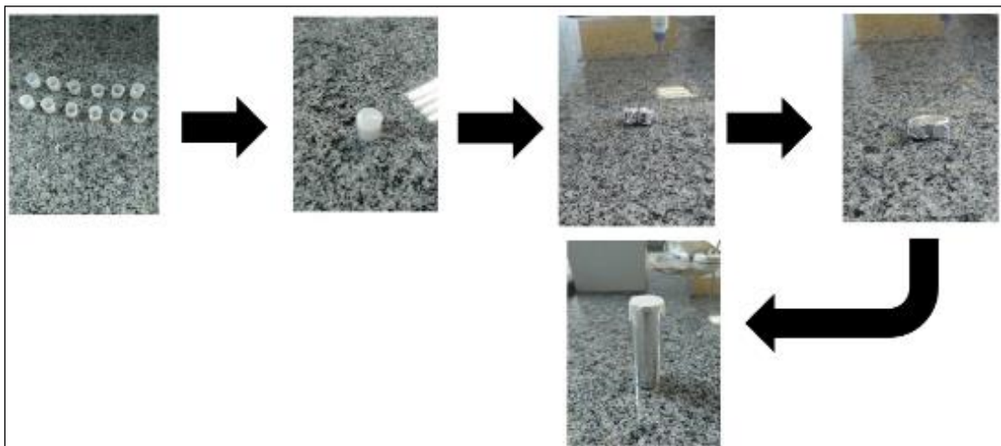
Figura 8 – Procedimento de empacotamento das amostras sintéticas e padrões para INAA.
