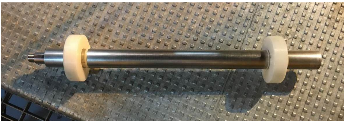
Figura B.4 – Detector proporcional de ^3\text{He} modo pulso n/s 8741 que foi utilizado nos treinamentos
