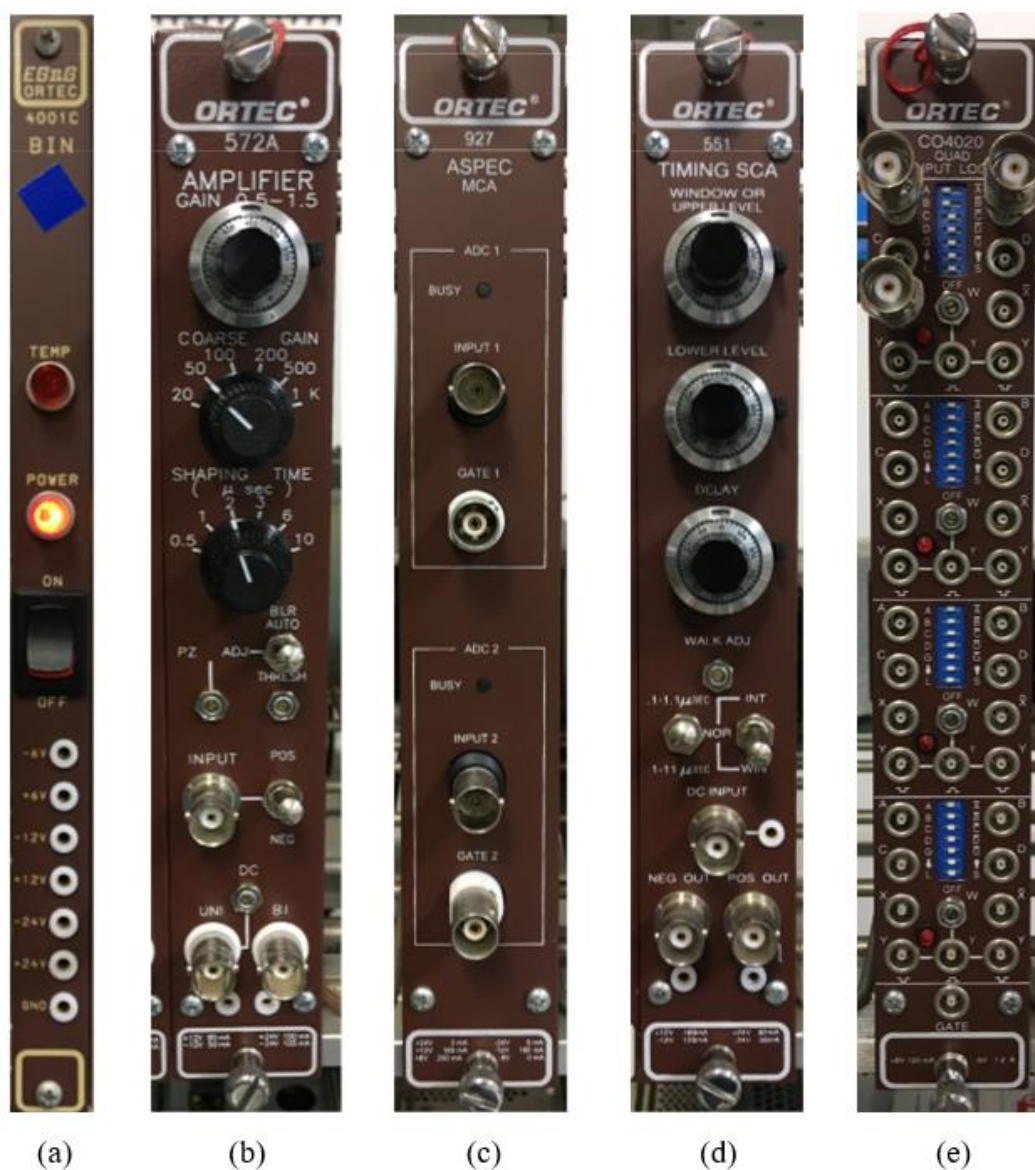
Figura B.18 - Módulos da Ortec: (a) Painel de controle do bastidor, (b) Amplificador, (c) Multicanal, (a) Monocanal e (d) Módulo de entrada lógica.
