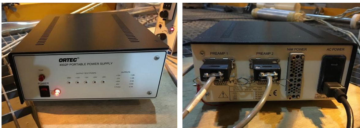
Figura B.9 - Fonte de alimentação do pré-amplificador ( Portable Power Supply )
