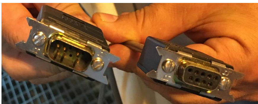
Figura B.10 – Cabo com conectores do tipo D de 9 pinos macho e fêmea
