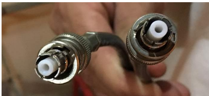
Figura B.8 - Cabo com conectores SHV-SHV
