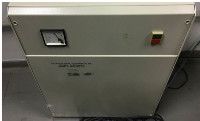
Figura B.14 – Estabilizador eletrônico de tensão alternada modelo 500 TRV-1A/I
