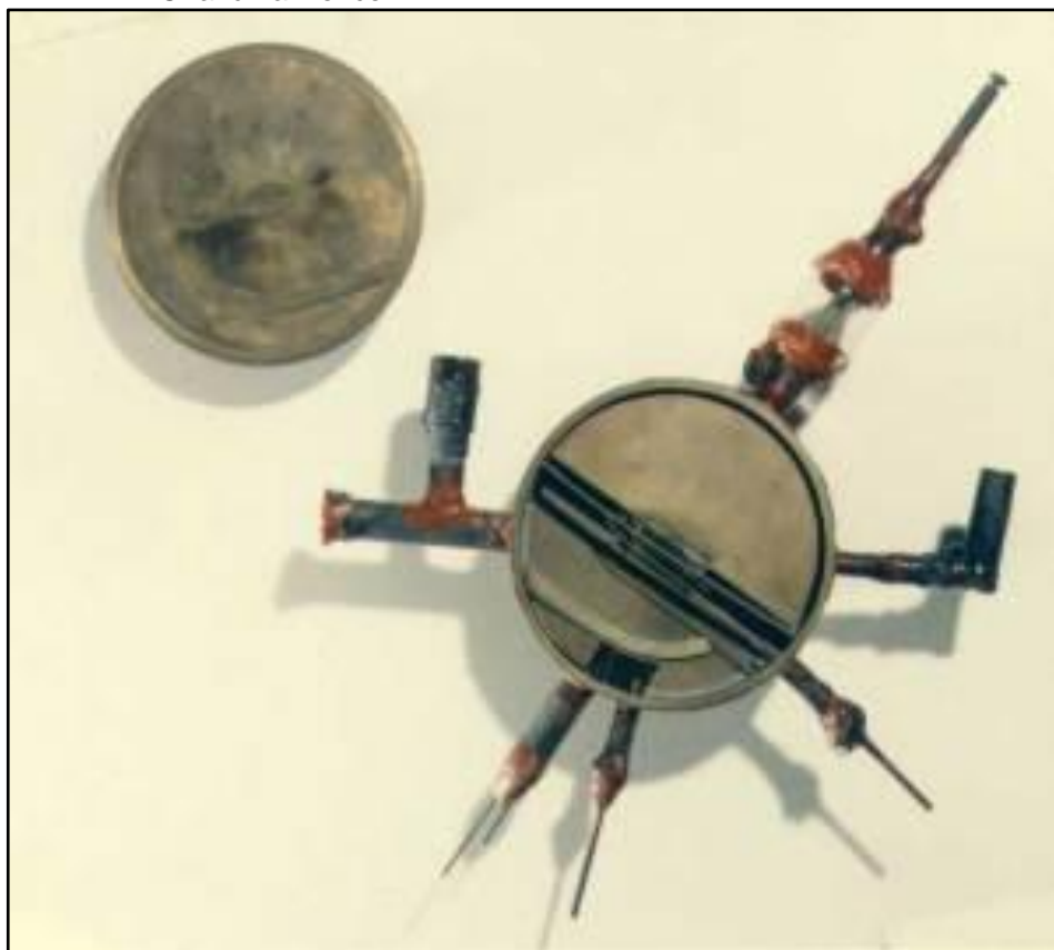
Figura 2 – Primeiro cíclotron de 11,43 cm construído pelo físico Ernest Orland Lawrence
