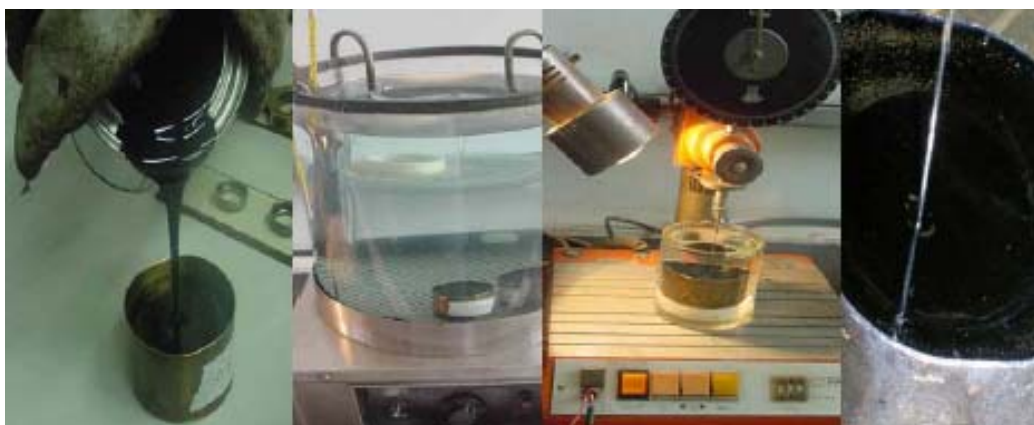
FIGURA 17: Moldagem, condicionamento, penetrômetro e detalhe da agulha (51)
