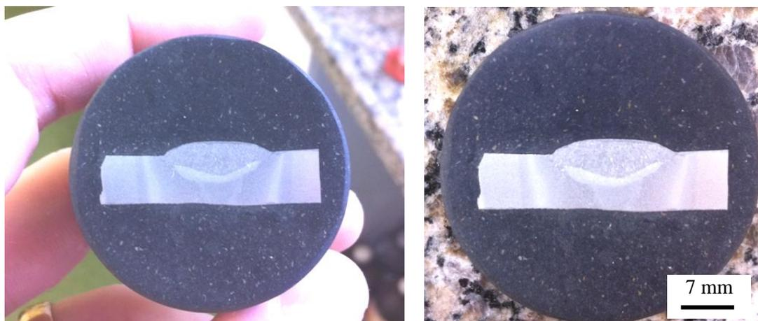
Figura 79. Ensaio macrográfico a olho nu na amostra embutida com ataque químico. FCAW-1. Fonte: o autor.
