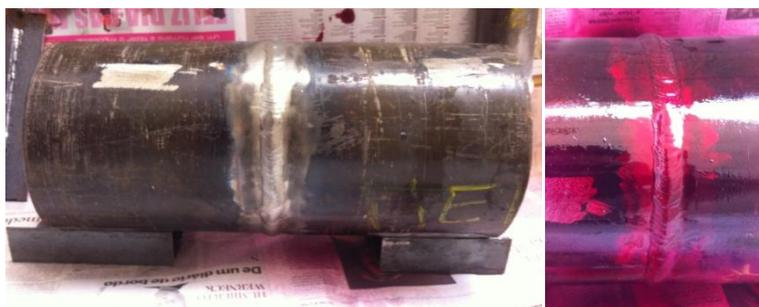
Figura 50. Ensaio não destrutivo de líquido penetrante. Limpeza e aplicação do líquido penetrante solúvel em água. SMAW-3. Fonte: o autor.
