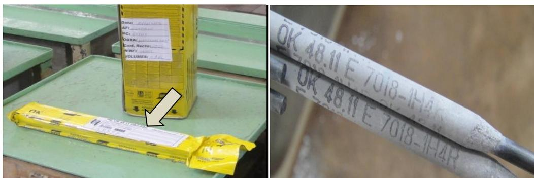
Figura 19. Consumíveis embalados a vácuo utilizados na soldagem com eletrodos revestidos. Fonte: o autor.
