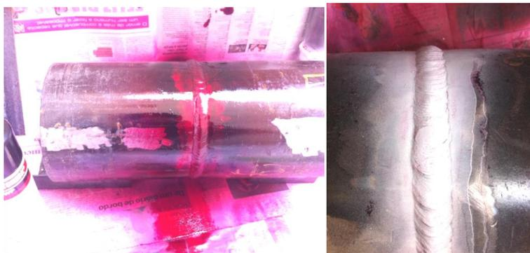
Figura 45. Ensaio por Líquido Penetrante em toda a circunferência da junta. SMAW-3 Fonte: o autor.
