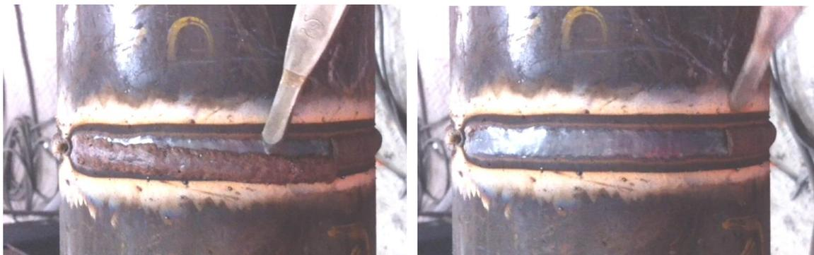
Figura 29. Remoção da escória após soldagem – FCAW-2. Fonte: o autor.
