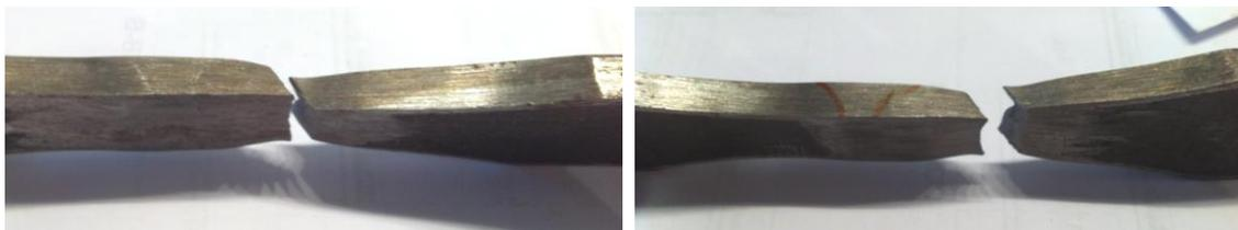
Figura 54. Amostras rompidas fora da ZF e ZAC. SMAW-1. Fonte: o autor.
