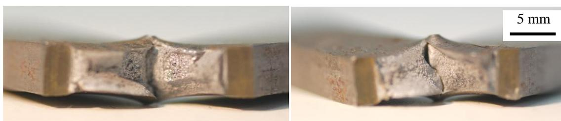
Figura 75. Amostras com entalhe localizado no MB. FCAW-1. Fonte: o autor.
