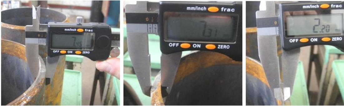
Figura 23. Medição da espessura do tubo nas extremidades e nariz. SMAW-1. Fonte: o autor.
