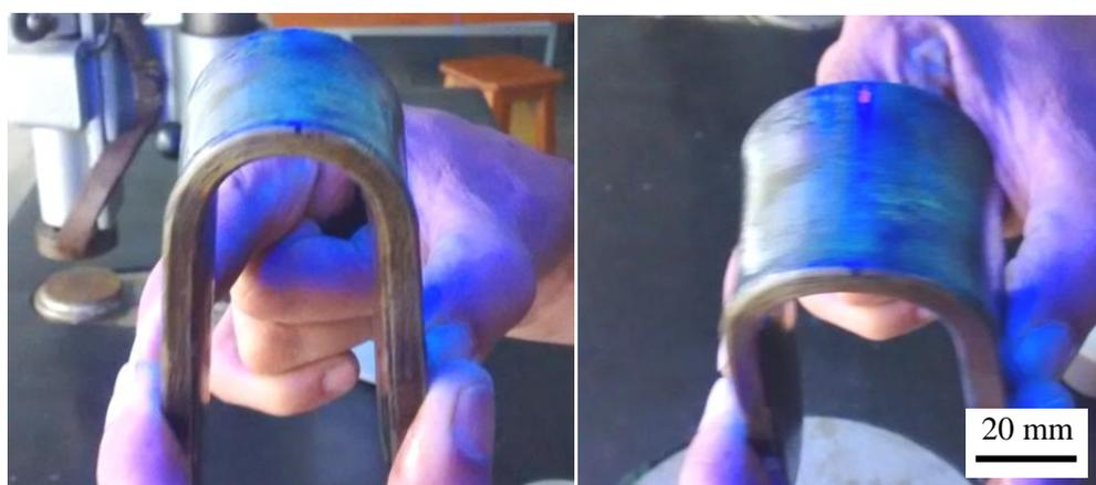
Figura 64. Amostras após o ensaio de líquido penetrante. SMAW-2. Fonte: o autor.
