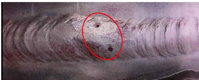
Figura 51. Ensaio não destrutivo de líquido penetrante. Porosidades isoladas. SMAW-3. Fonte: o autor.
