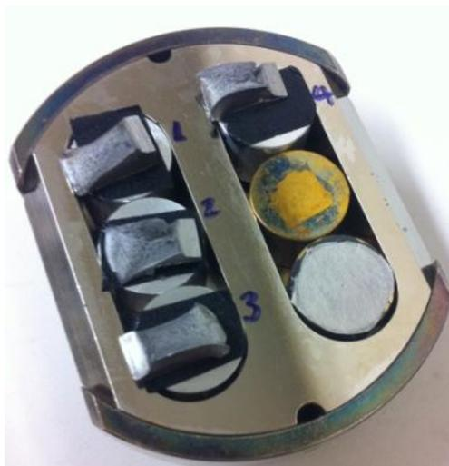
Figura 98. Porta-amostra do microscópio eletrônico com quatro amostras do ensaio de impacto. FCAW-2.
