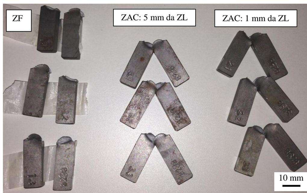
Figura 73. Amostras após ensaio de impacto. SMAW-3. Fonte: o autor.
