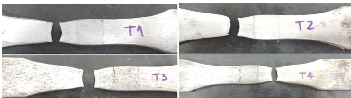
Figura 55. Amostras rompidas fora da ZF após o ensaio de tração. SMAW-2. Fonte: o autor.
