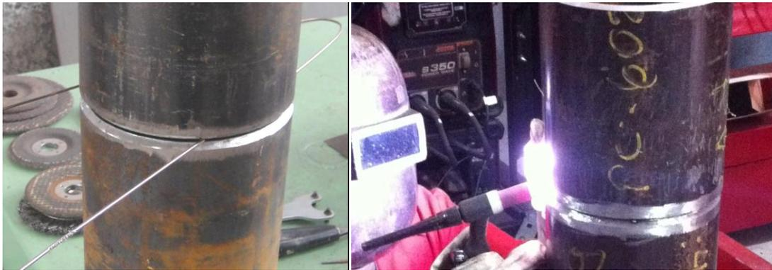
Figura 24. Utilização do arame espaçador para determinar a abertura de raiz. SMAW-1. Fonte: o autor.
