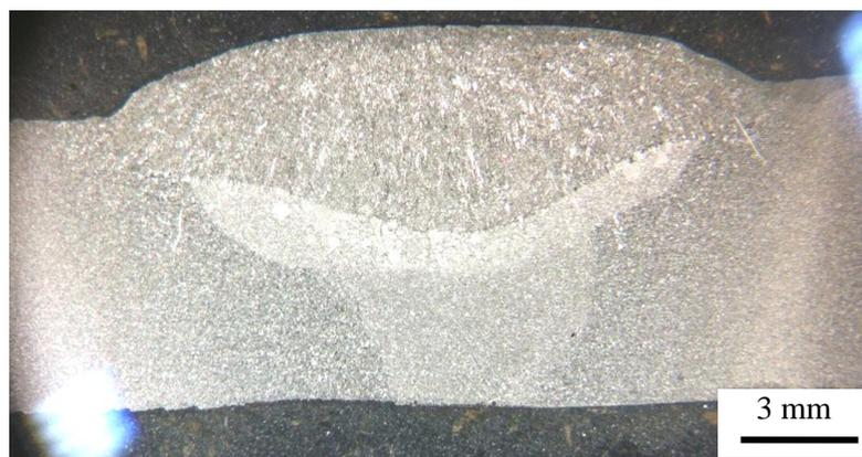
Figura 105. Exemplo de ensaio macrográfico. FCAW-1. Fonte: o autor.
