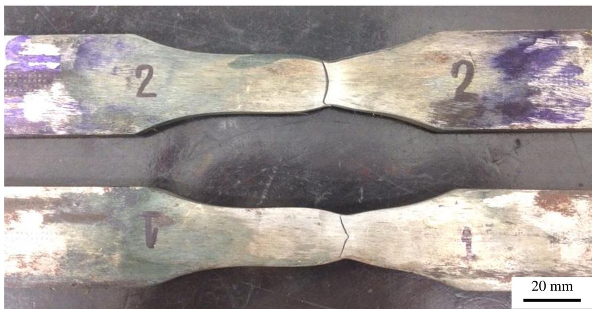
Figura 57. Amostras rompidas no MB após ensaio de tração. SMAW-3. Fonte: o autor.
