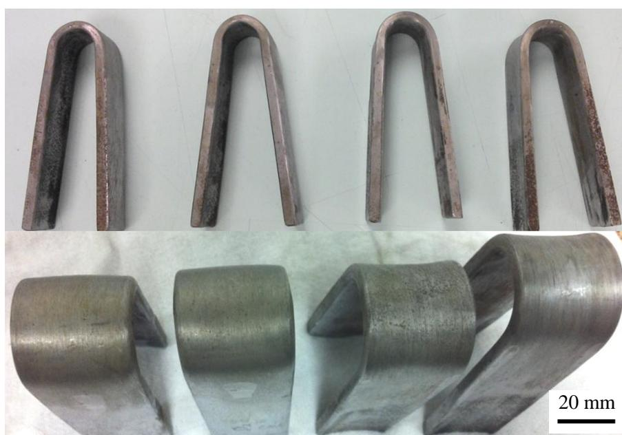
Figura 66. Amostras após dobramento. Na sequência da figura: DF1, DF2, DR1 e DR2. FCAW-1. Fonte: o autor.
