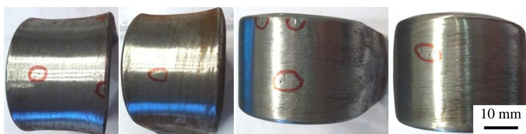
Figura 61. Amostras após o ensaio de dobramento. SMAW-1. Fonte: o autor.
