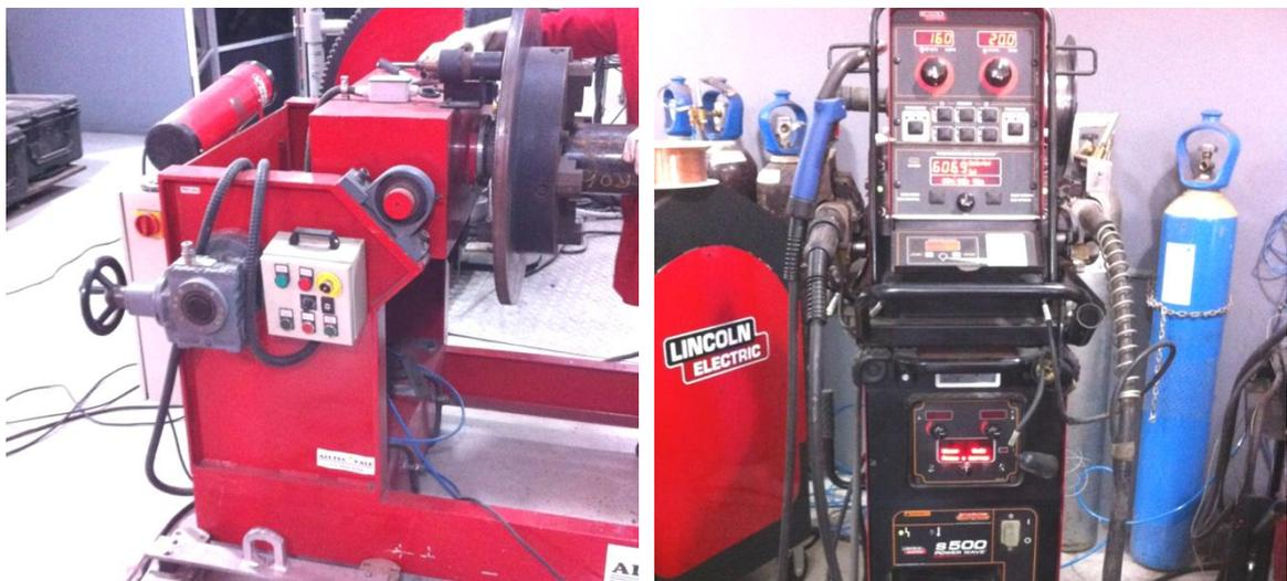
Figura 28. Dispositivo de rotação e equipamento para soldagem da peça de teste – FCAW-2. Fonte: o autor.
