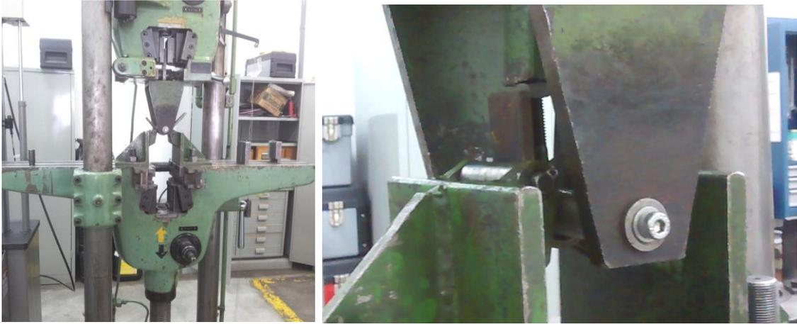
Figura 36. Equipamento utilizado no ensaio de dobramento e amostra durante o ensaio. Fonte: o autor.
