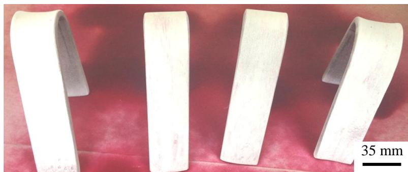
Figura 65. Amostras com revelador após o ensaio com líquido penetrante. SMAW-3. Fonte: o autor.
