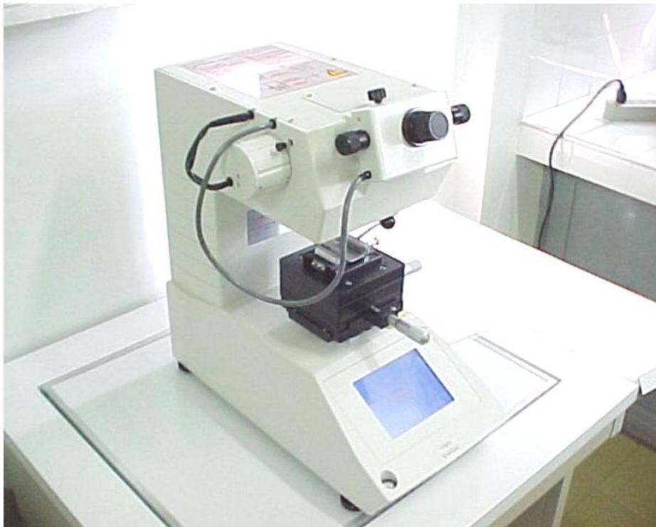
Figura 40. Microdurômetro convencional de bancada do fabricante SHIMADZU HMV-2. Fonte: o autor.
