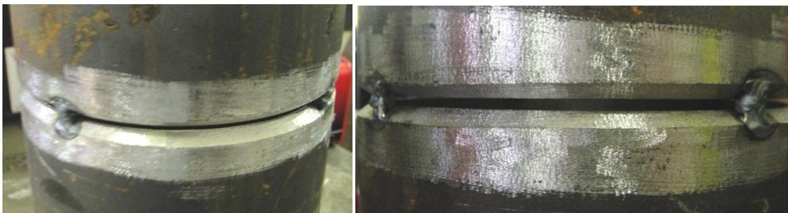
Figura 25. Peça de teste ponteadada nas posições 3, 6, 9 e 12 h. SMAW-2. Fonte: o autor.
