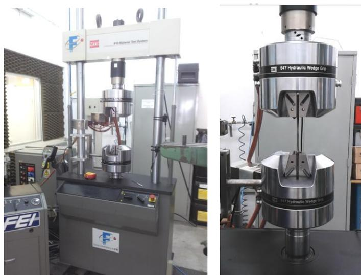
Figura 32. Equipamento utilizado para o ensaio de tração. Fonte: o autor.
