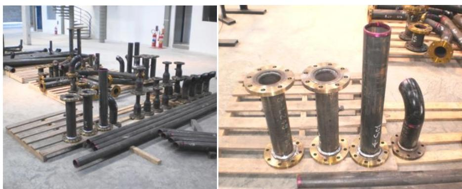
Figura 4. Spools do sistema de refrigeração e ar condicionado em refinarias. Fonte: o autor.
