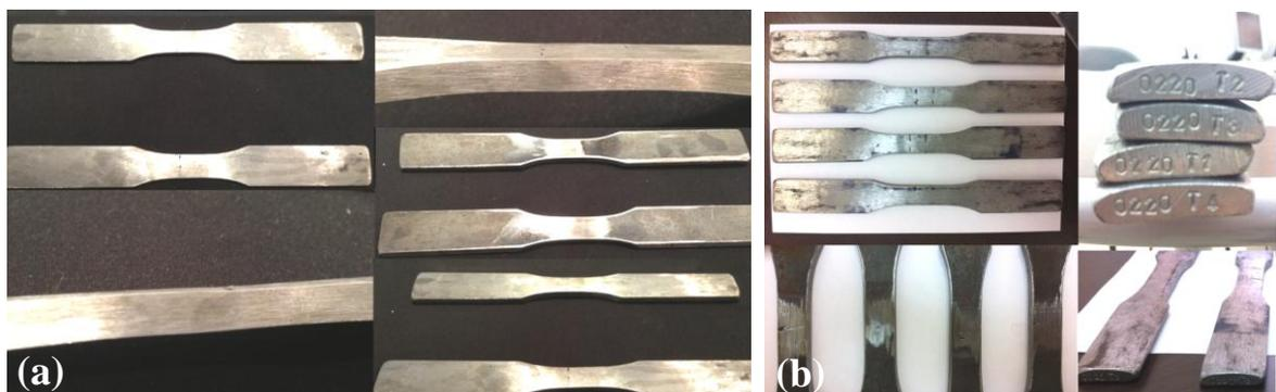
Figura 31. Amostras para ensaio de tração. (a) SMAW-1 e (b) SMAW-2. Fonte: o autor.
