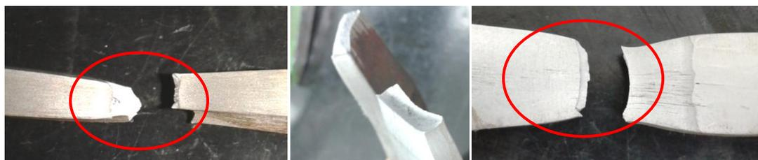
Figura 56. Formato taça-cone no local do rompimento das amostras. SMAW-2. Fonte: o autor.
