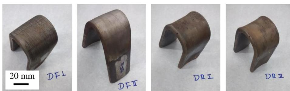
Figura 63. Amostras após o ensaio de dobramento. SMAW-2. Fonte: o autor.
