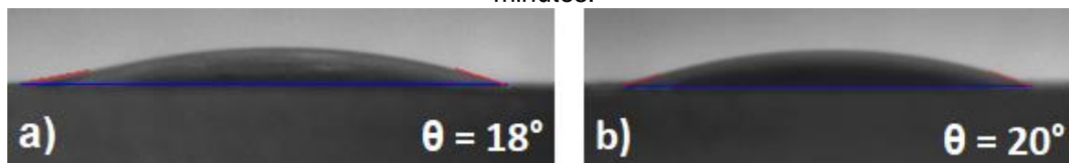
Figura 21: Perfil da gota de água deionizada (5 \mu L) sobre a superfície dos filmes de ZnO depositados a frio, com 10 passes e tratados termicamente a a) 450°C e b) 500°C por 45 minutos.
