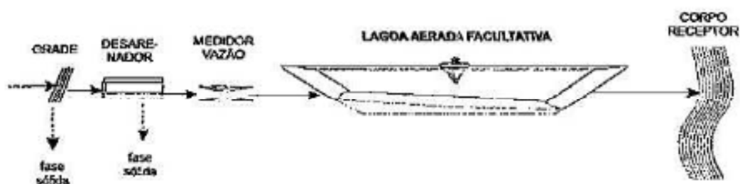
Figura 3.14 - Fluxograma de um sistema de lagoas aeradas facultativas - Fonte: Von Sperling (2005)
