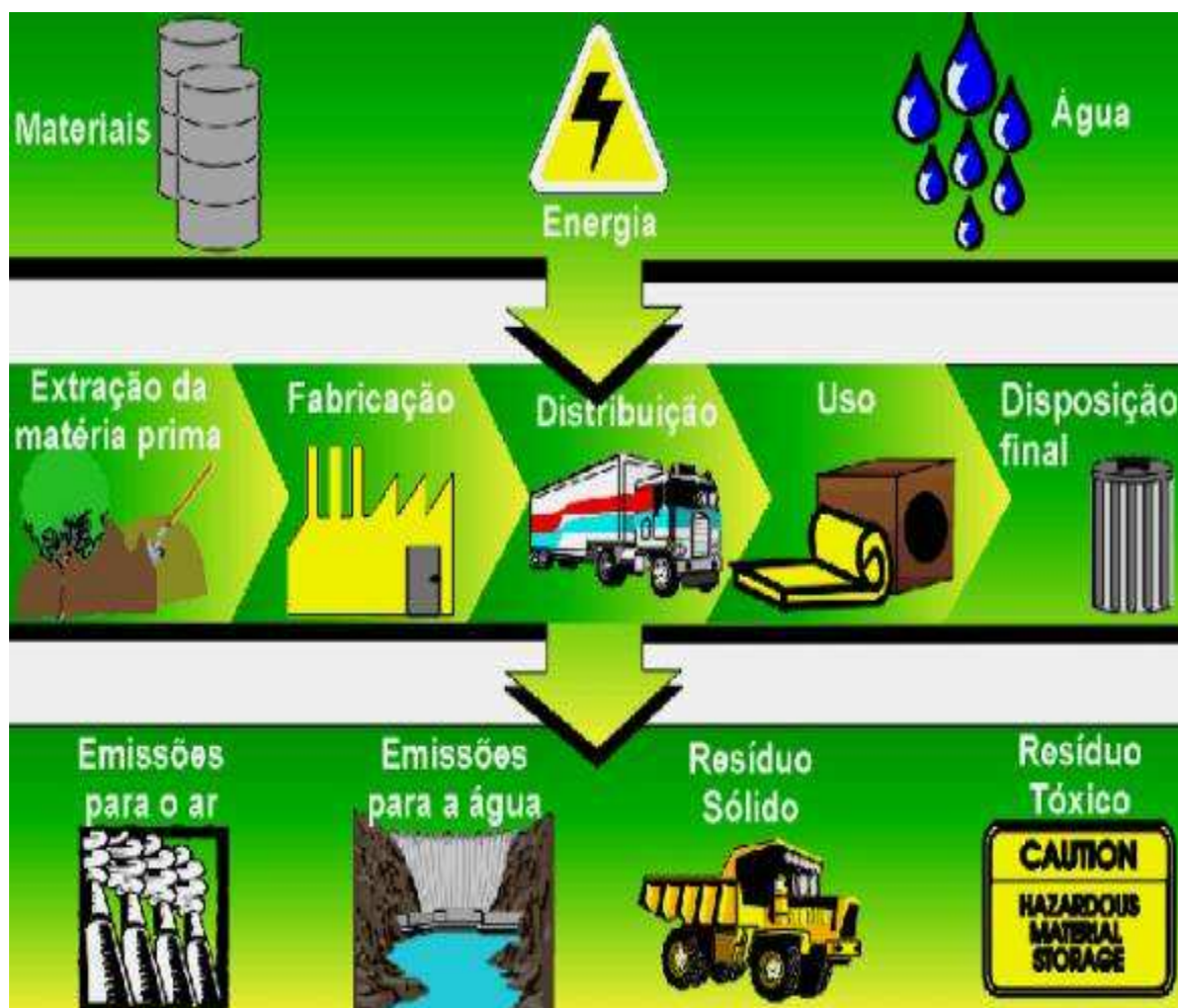
Figura 3.23 - Estágios do Ciclo de Vida de um produto (Prado e Kaskantzis Neto, 2005)
