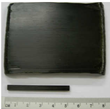
FIGURA 4.21 – Placa do compósito curado pelo processo térmico e um corpo-de-prova de DMTA.
