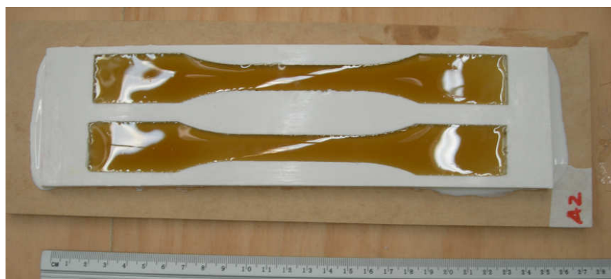
FIGURA 4.6 – Molde de silicone para corpos-de-prova de tração de matriz polimérica.
