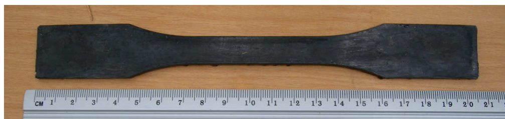
FIGURA 4.9 – Corpo-de-prova de tração da matriz curado por feixe de elétrons.
