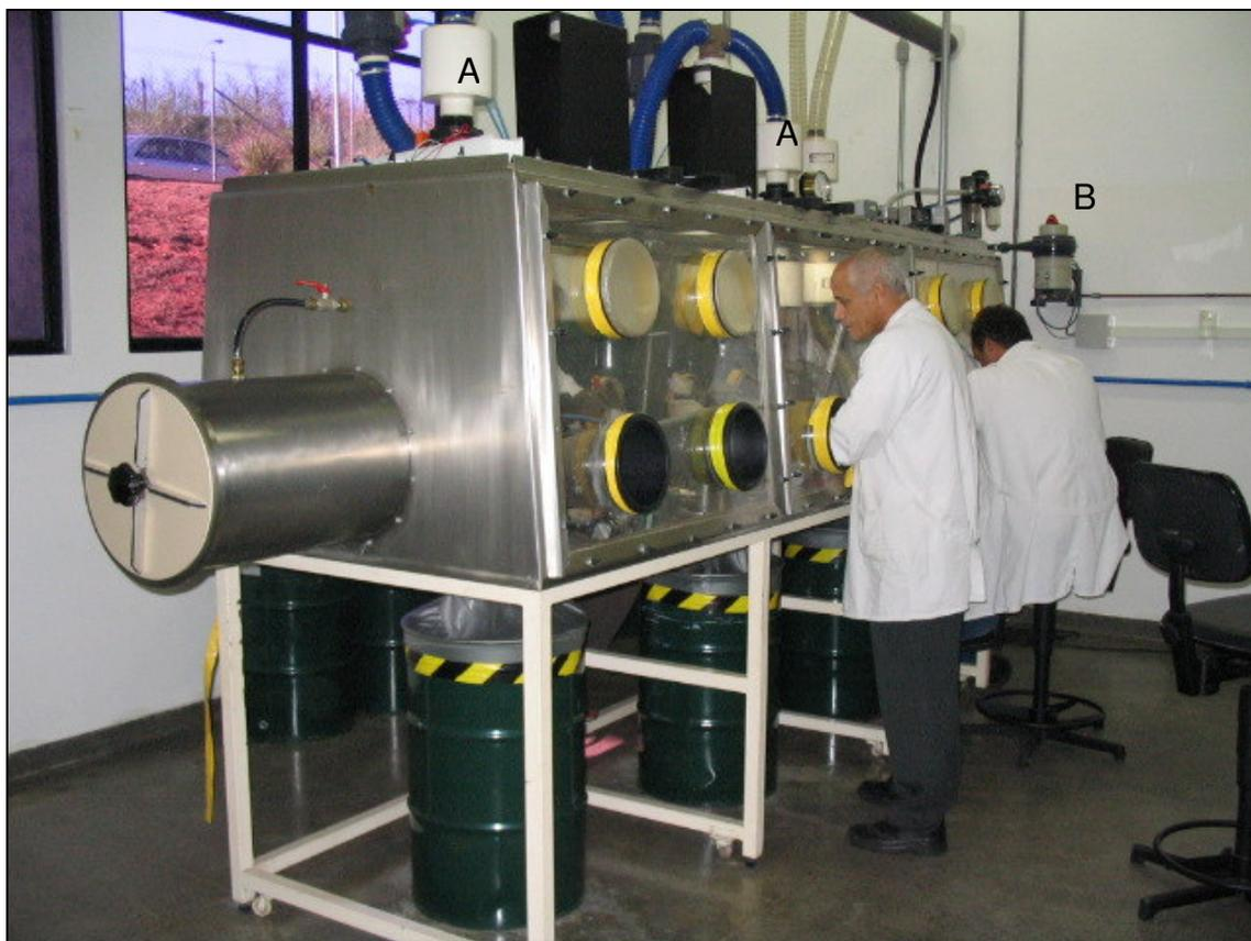
Figura 3.6: Caixa de luvas para desmontagem de pára-raios radioativos, do Laboratório de Rejeitos Radioativos do IPEN. (A) Filtros HEPA; (B) Monitor de ar.
