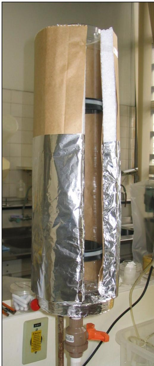
Figura 4.2: Revestimento do lisímetro com papel kraft, isopor e papel alumínio
