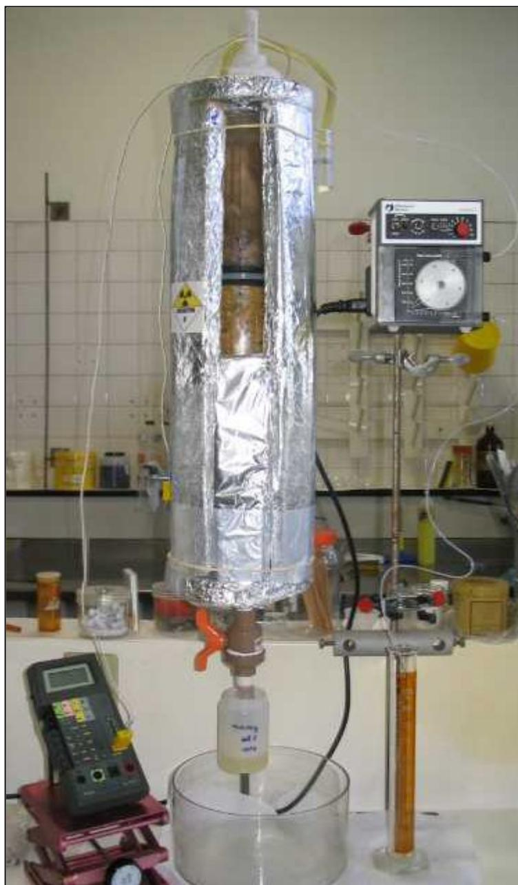
Figura 4.3: Lisímetro de acrílico preenchido com resíduo orgânico.
