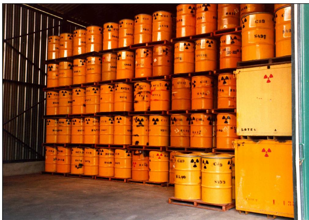
Figura 3.10: Depósito provisório de rejeitos radioativos do IPEN.
