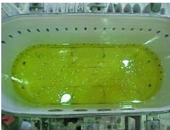
Figura 29 - Vista do Fundo do tanque do transformador, com resíduos desprendidos do núcleo amorfo
