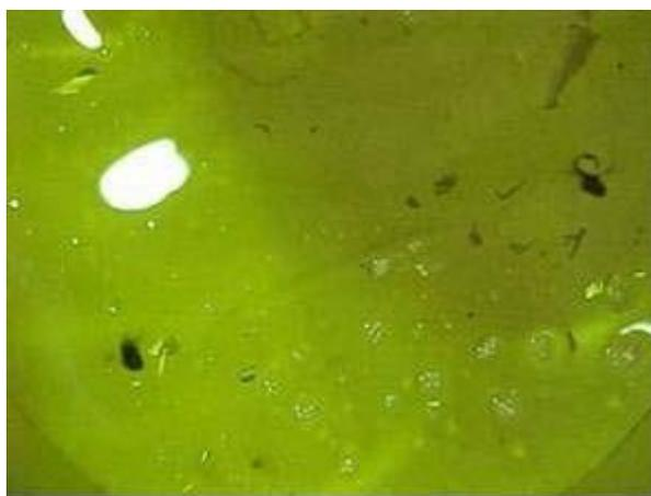
Figuras 36 e 37 - Vista do Fundo do tanque do transformador, com resíduos desprendidos do núcleo amorfo no óleo e pontos de deterioração na pintura causados por atrito da fixação da parte ativa.
