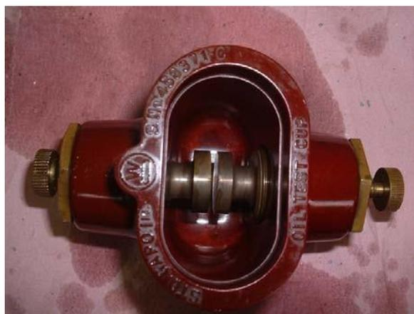
Figuras 17 e 18 - Detalhe do ensaio de rigidez dielétrica e cuba utilizada no ensaio
