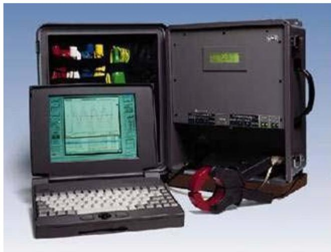
Figura 14 - Vista do Medidor de Distorções Harmônicas acoplado ao Notebook de coleta dos dados
