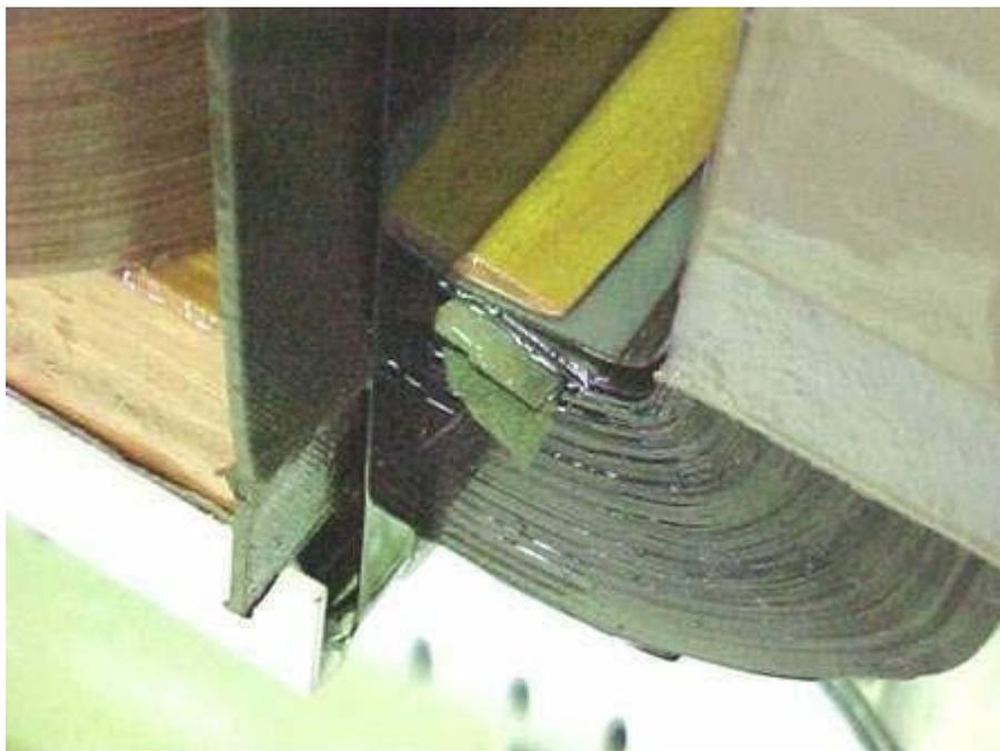
Figura 33 - Detalhe da junção do núcleo amorfo, mostrando fragmentação na superposição das lâminas
