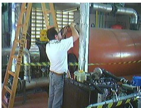
**Figura 6.29 – Coleta de amostra dos gases de exaustão do grupo gerador**
