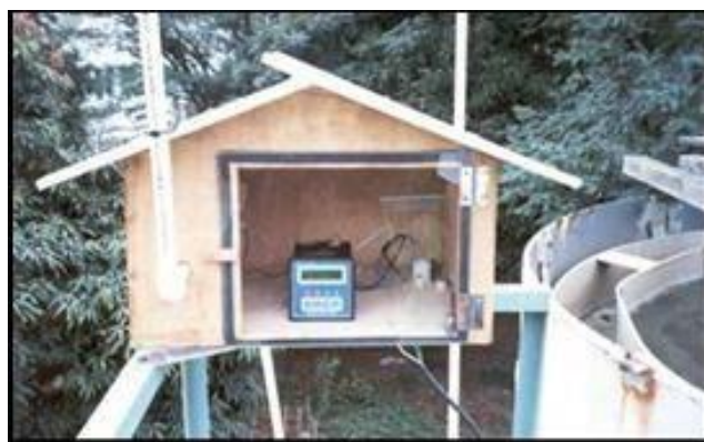
Figura 35. Totalizador da vazão de biogás instalado no abrigo de madeira. Fonte: CENBIO, 2004g.
