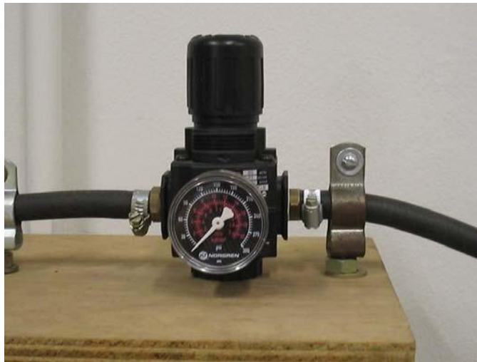
Figura 5.10 – Regulador de pressão do ensaio de névoa salina, IEE/USP (Foto: C. M. Ramos, 2005).
