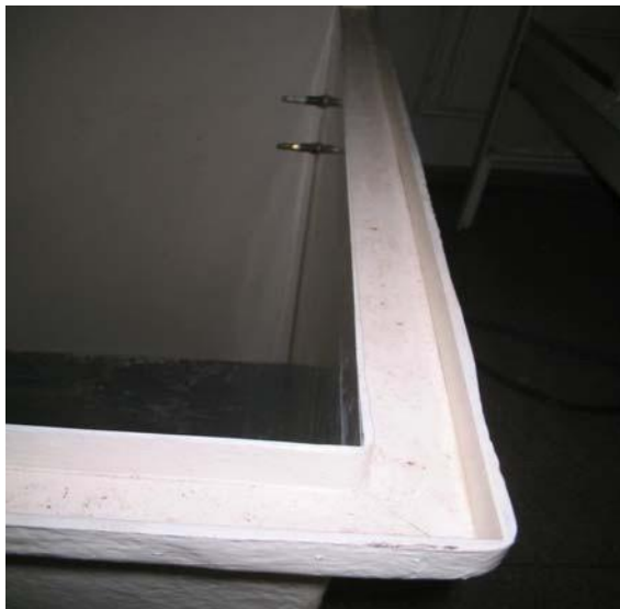
Figura 5.6 – Detalhe do selo d'água, IEE/USP (Foto: C. M. Ramos, 2005).
