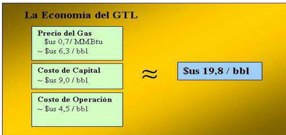
Figura 7. 9 - Custo aproximado do diesel de GTL-FT
