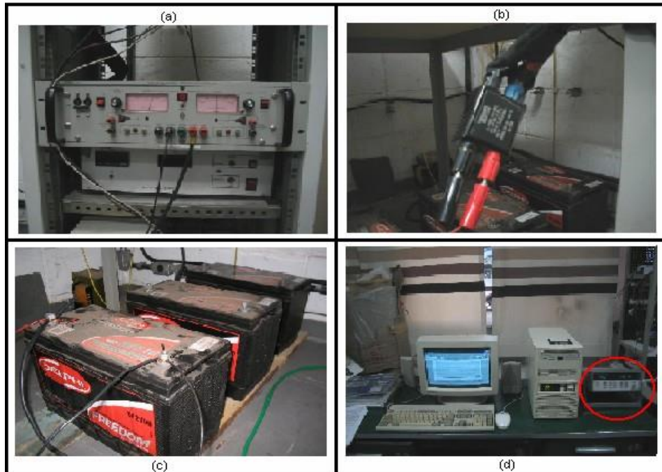
Figura 3.18. Elementos que constituem a bancada de teste dos acumuladores. (a) Fonte de tensão e corrente regulada, (b) shunt, (c) acumuladores, (d) microcomputador e datalogger (círculo vermelho)
