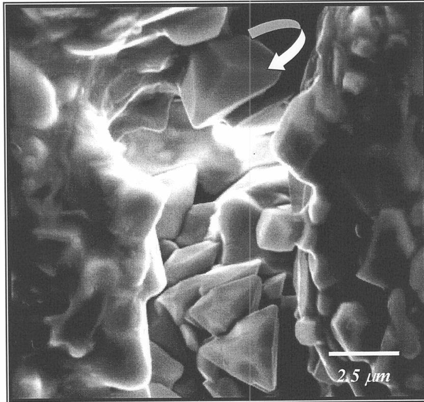
*Figura 4.26* - Micrografia no interior da fratura da amostra cristalizada a  $6^\circ\text{C}/\text{min}$  evidenciando a presenç de cristais piramidais.
