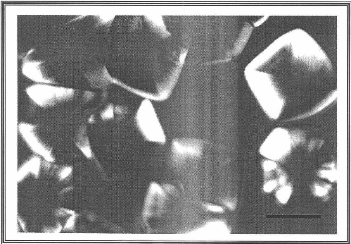
**Figura 4.28** - Região cristalizada em lâminas de composição  $50\text{BiO}_{1,5}:50\text{GeO}_2$ . A escala corresponde a  $100\mu\text{m}$ .
