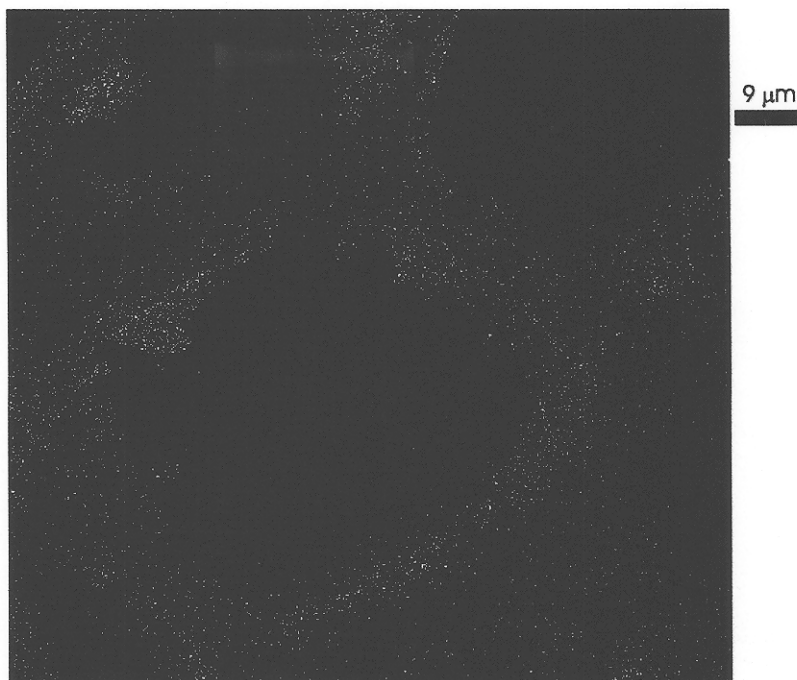
FIGURA 4.20 - Mapeamento de Si por emissão de raios-X a partir da mesma região mostrada na FIGURA 4.19 . Madeira com 6,4 % em peso de TEOS. Os pontos claros coincidem com as paredes celulares de FIGURA 4.19, indicando que houve impregnação das paredes com gel de TEOS.
