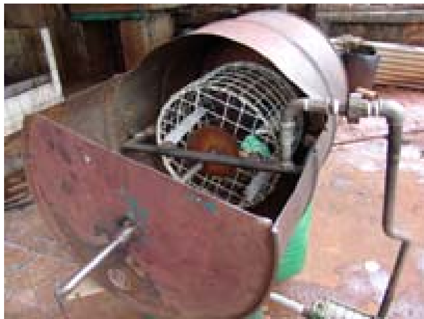
Figura 12. Tambor de metal com cesto cilíndrico operado manual e mecanicamente.
