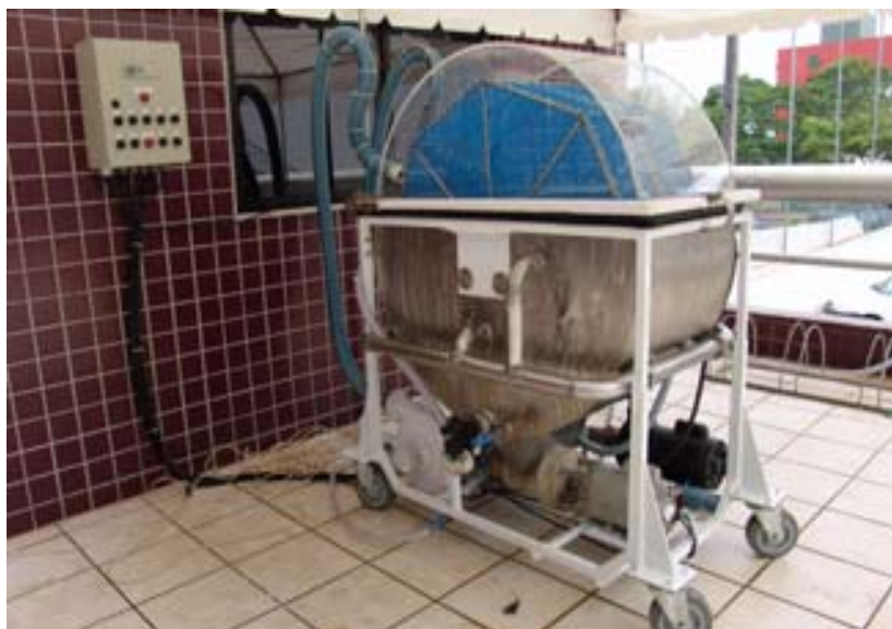
Figura 18. Fotografia do sistema automatizado de tratamento e descarte de meios de cultura contaminados.
