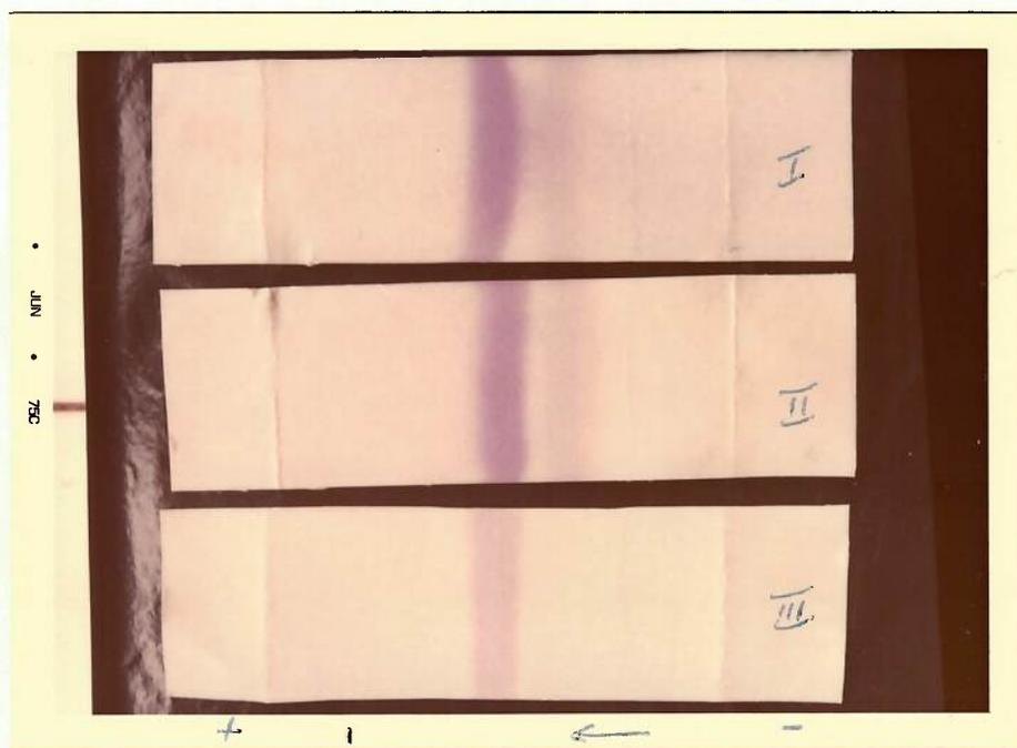
FIGURA 4. SEPARAÇÃO DE ÁCIDO 3-METOXI-4-HIDROXIMANDÉLICO PELO MÉTODO MODIFICADO.
