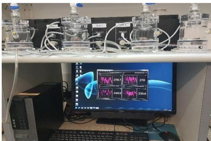
Figura 21 – Câmaras plestimográficas (BUXCO Research Systems) utilizadas para mensurar o padrão respiratório.
