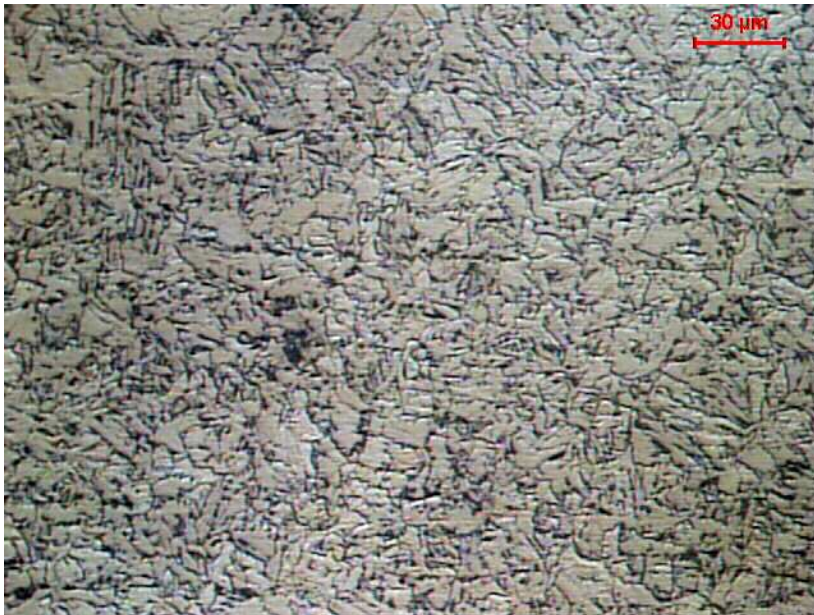
Figura 37. Fotomicrografia da região da Solda-ZTA do aço RD480. Ampliação de 500x. Ataque químico: Nital 3%.
