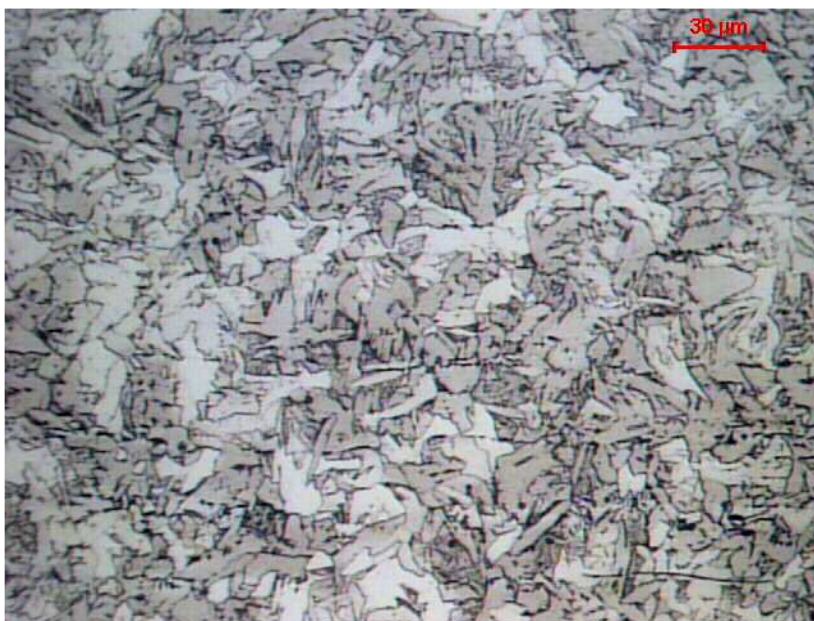
Figura 35. Fotomicrografia do Metal Base do aço S275JR. Ampliação de 500x. Ataque químico: Nital 3%.
